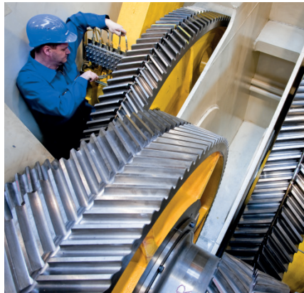
Das Herzstück einer mechanischen Presse: der Radsatz im Kopfstück.
