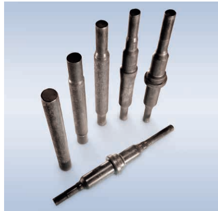
Stadienfolge bei der Kaltumformung von Wellen.
