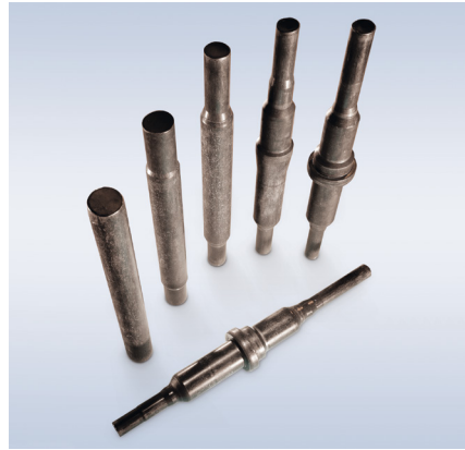
Stadienfolge bei der Kaltumformung von Wellen.
