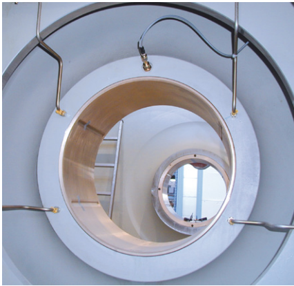
Schmierung eines Lagers an einer Exzenterwelle.
