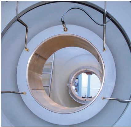
Schmierung eines Lagers an einer Exzenterwelle.
