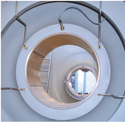
Schmierung eines Lagers an einer Exzenterwelle.
