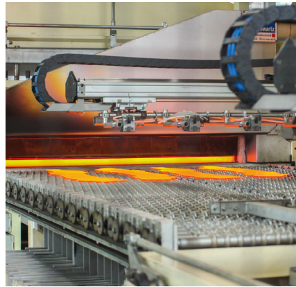
Formhärte Teile nach Verlassen des Ofens.
