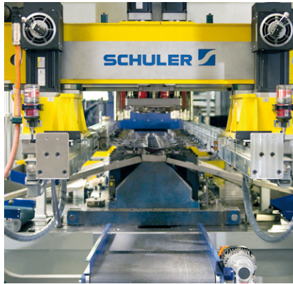
Produktion mit Servopresse und elektro-nischem Drei-Achs-Transfer.
