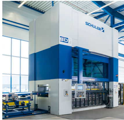
Automatisierte Servopresse bei PROTEC.
