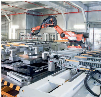
Entstapelroboter mit Scherenhubtisch und automatisch anstellbaren Spreizmagneten.
