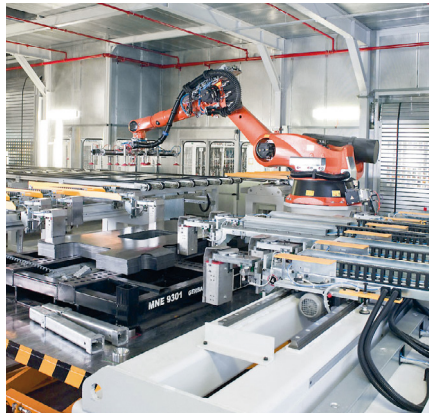
Entstapelroboter mit Scherenhubtisch und automatisch anstellbaren Spreizmagneten.
