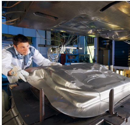
Ermittlung optimaler Prozessparameter im Tryout – Voraussetzung für einen stabilen Serienprozess. © Fraunhofer IWU
