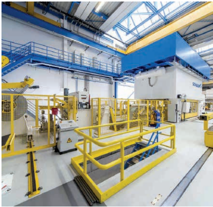
Schneid- und Umformsystem mit Bandzuführanlage.
