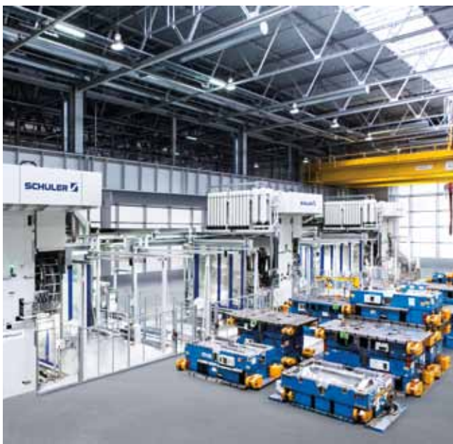
Presse hydraulique pour matières plastiques à entraînement par accumulateur.
