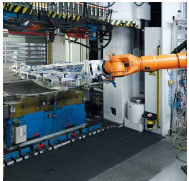
Fabrication en série automatisée par robots des toits en carbone.
