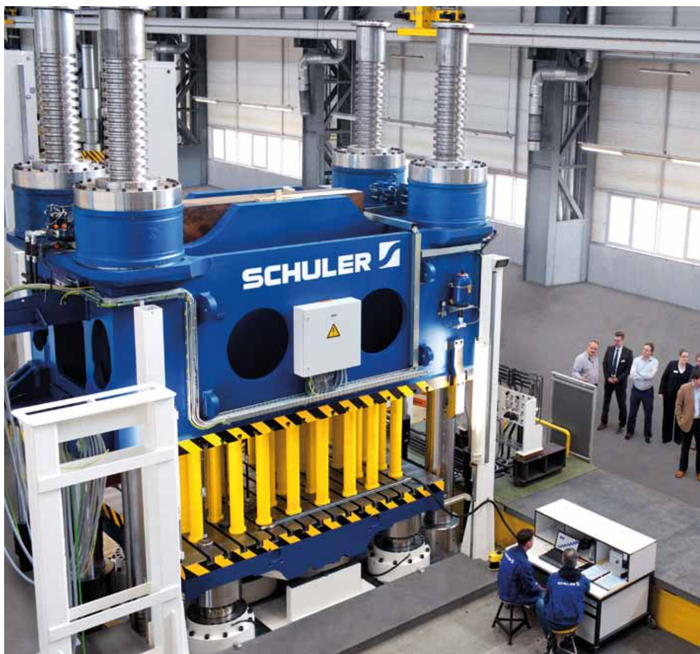
Presse hydraulique pour matières plastiques dans le grand montage chez Schuler.
