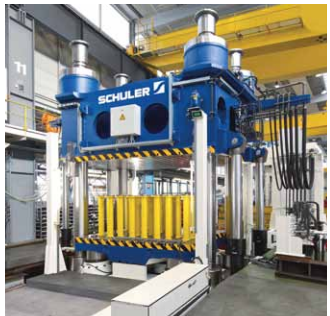
Presse hydraulique à faible course pour l'usinage des matières plastiques renforcées de fibres.
