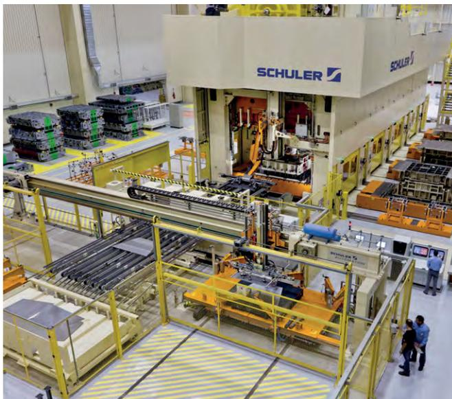
Linha de prensas mecânicas high-speed, automatizada com crossbar feeder.
