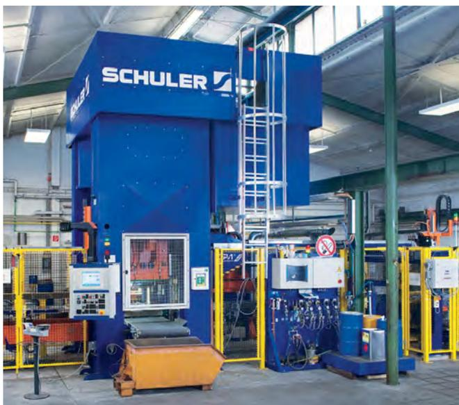
Prensa mecânica para forjamento.
