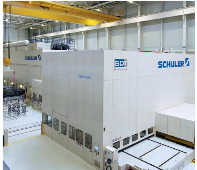
Linha de prensas servo-acionadas de seis estações, automatizada com crossbar feeder.
