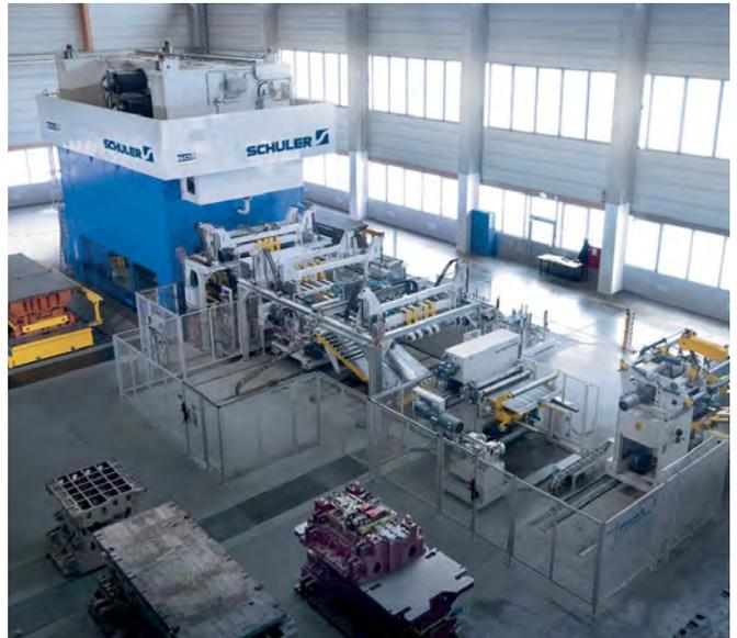
Prensa servo-acionada com tirantes, 1600 t, em combinação com linha de alimentação de bobinas e desempilhador.
