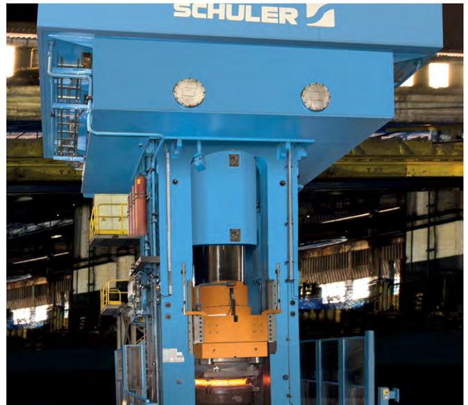
Prensa hidráulica para forjamento, 3000 t.
