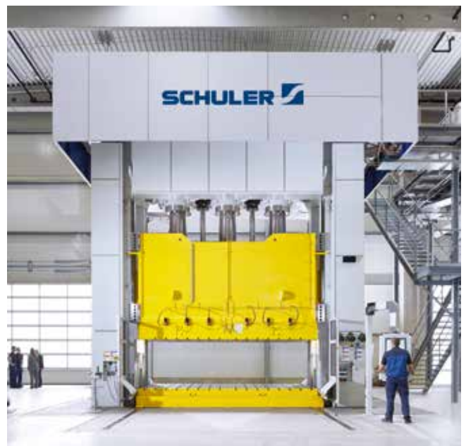
Hydraulische Tryoutpressen ermöglichen die schnelle Einarbeitung von Ziehwerkzeugen.
