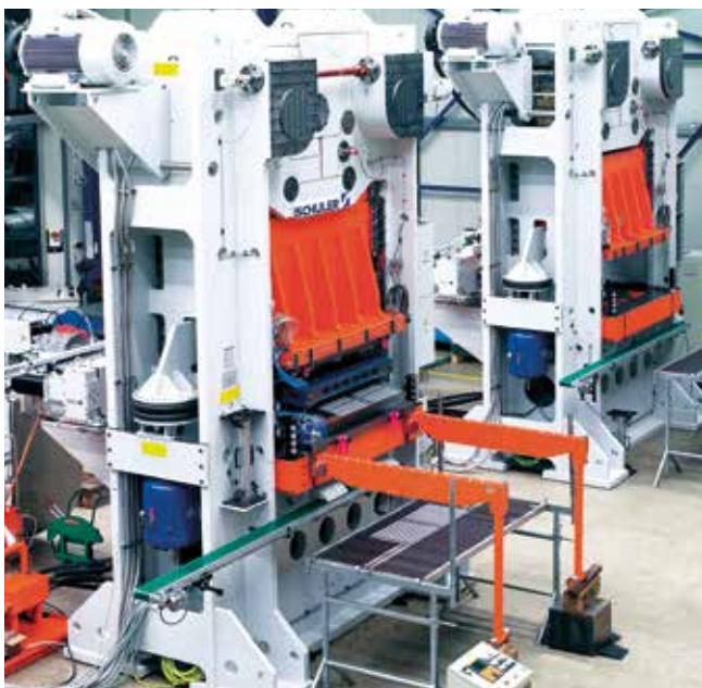
Heizkörperpresse RMK 1500 mit Doppelkniehebel-Oberantrieb.
