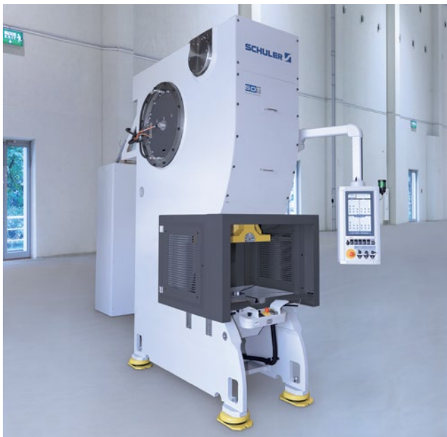
Stanzautomat CSC 100 mit fünf vorprogrammierten Stößelbewegungskurven zum Schneiden, Prägen, Biegen, Ziehen und Umformen.
