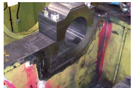
Schweißnähte kerbarm verschliffen und Lagendurchmesser fertig bearbeitet.
