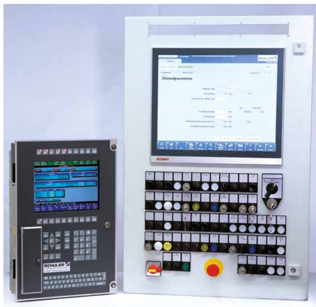
Alte und neue Steuerung (von links).
