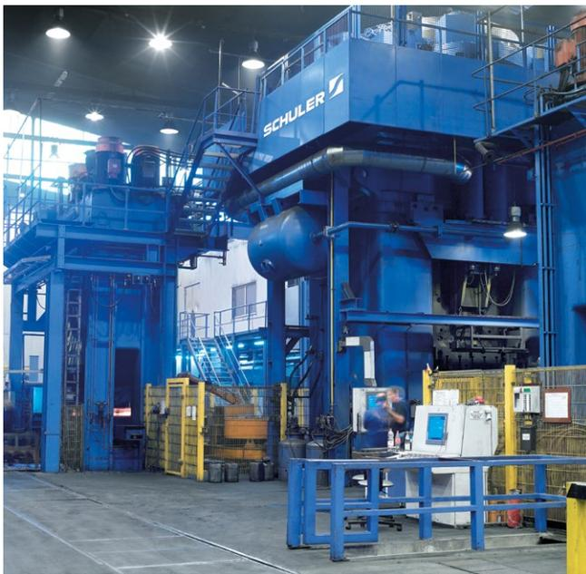
Spindelpresse und hydraulische Abgratpresse in einer Schmiedelinie.
