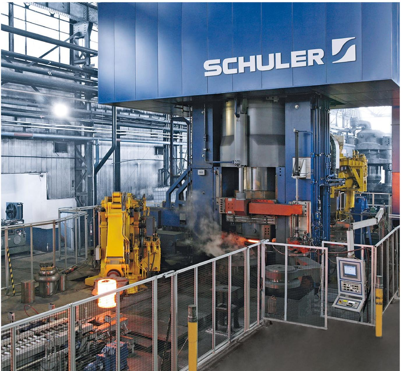
Hydraulische Presse zum Schmieden von Eisenbahnrädern.
