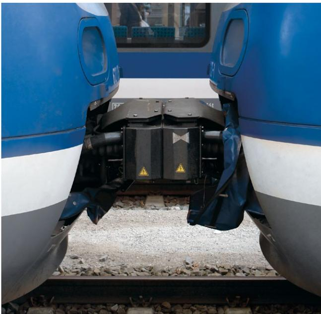
Einsatz von Schmiedeteilen in automatischen Kupplungen.
