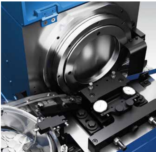
Randpräge- und Stauchmaschine RS 50 für runde Münzplatinen.
