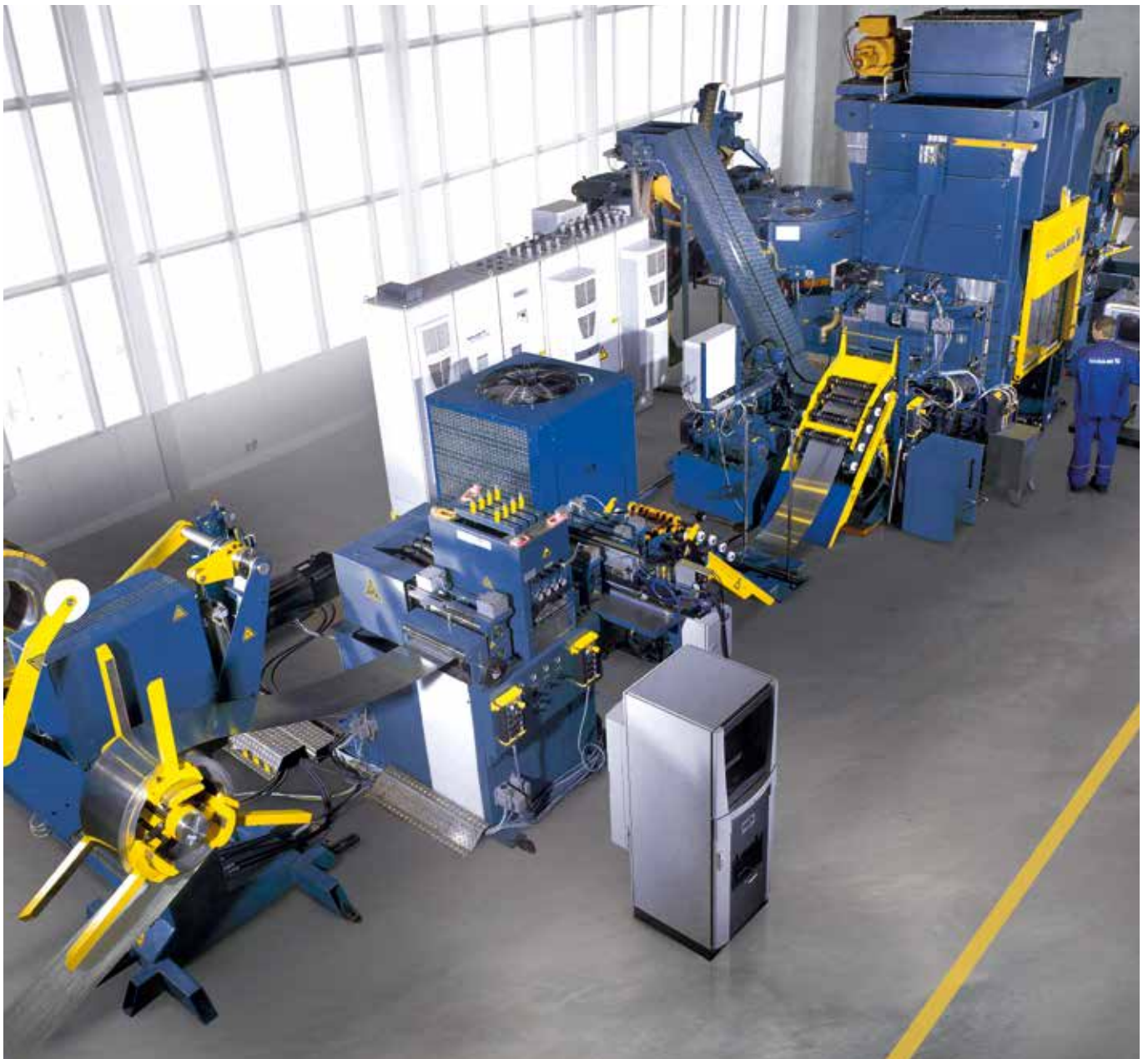
Blankmaster SAK – Anlage für die Herstellung von Münzplatinen.
