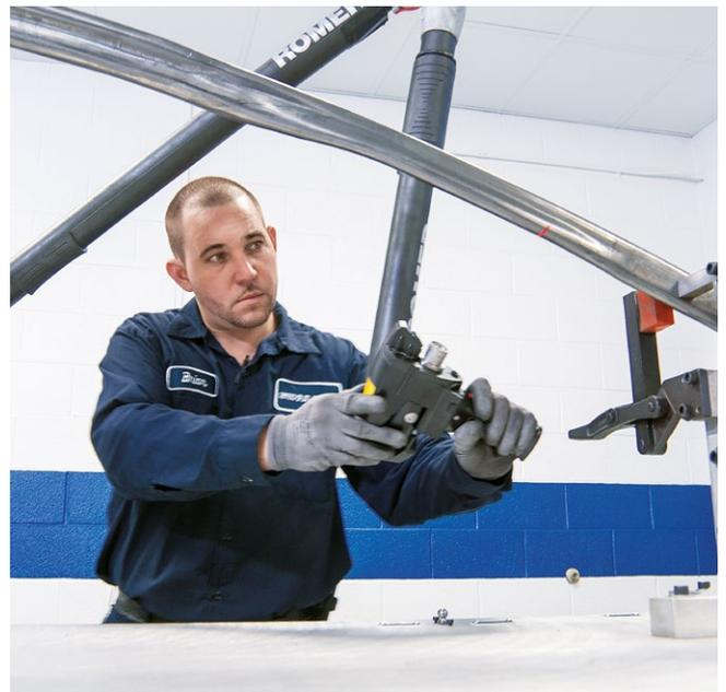
Laservermessung in der Bauteilentwicklung.
