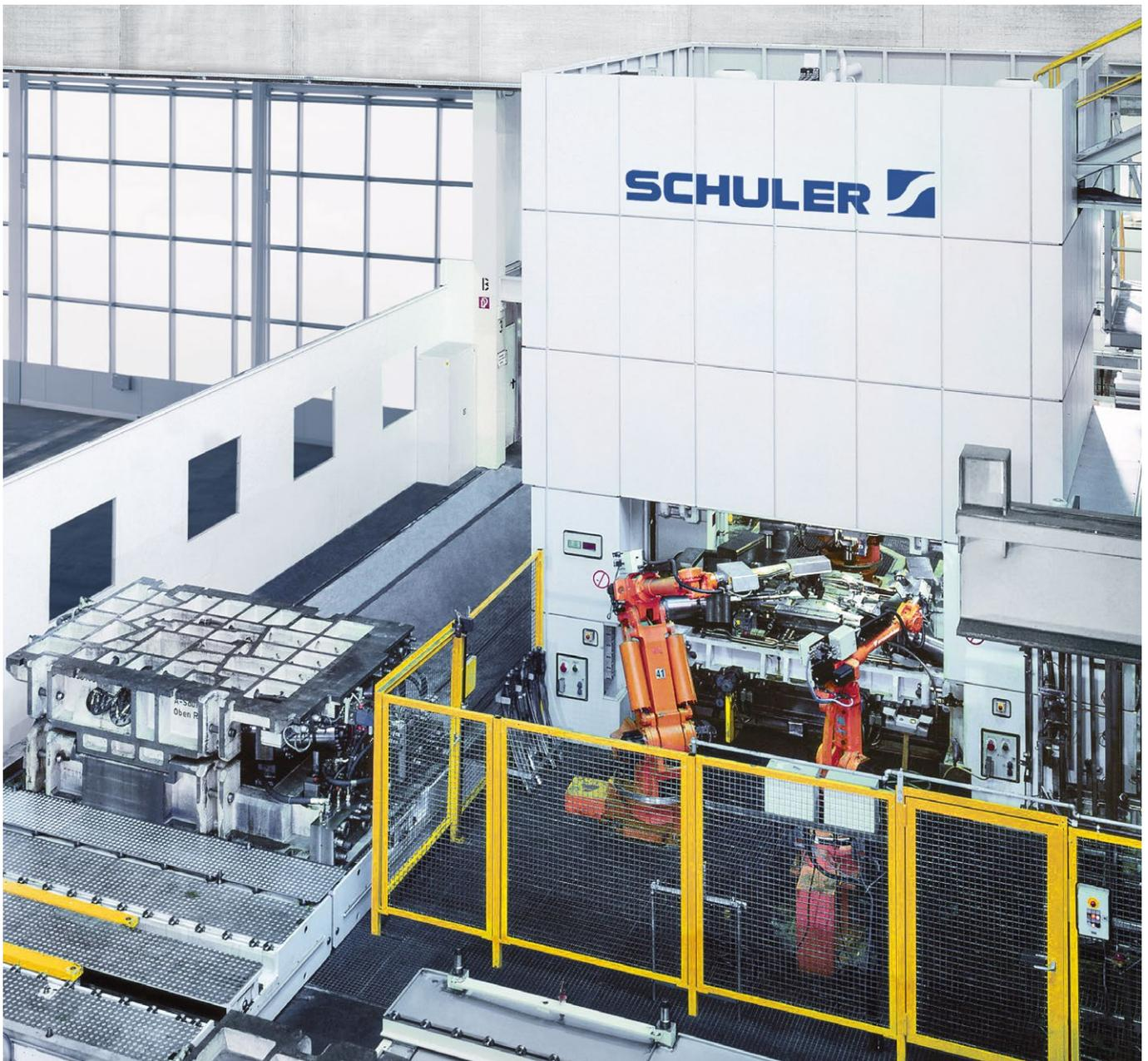
Vollautomatische IHU-Anlage eines deutschen Automobilherstellers.
