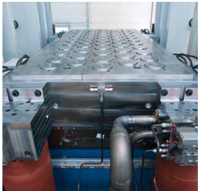
Multizylindertechnik während der Inbetriebnahme.
