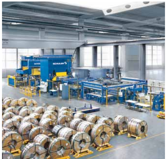
Voll automatisierte Anlage zur Herstellung von Wärmetauscherplatten.
