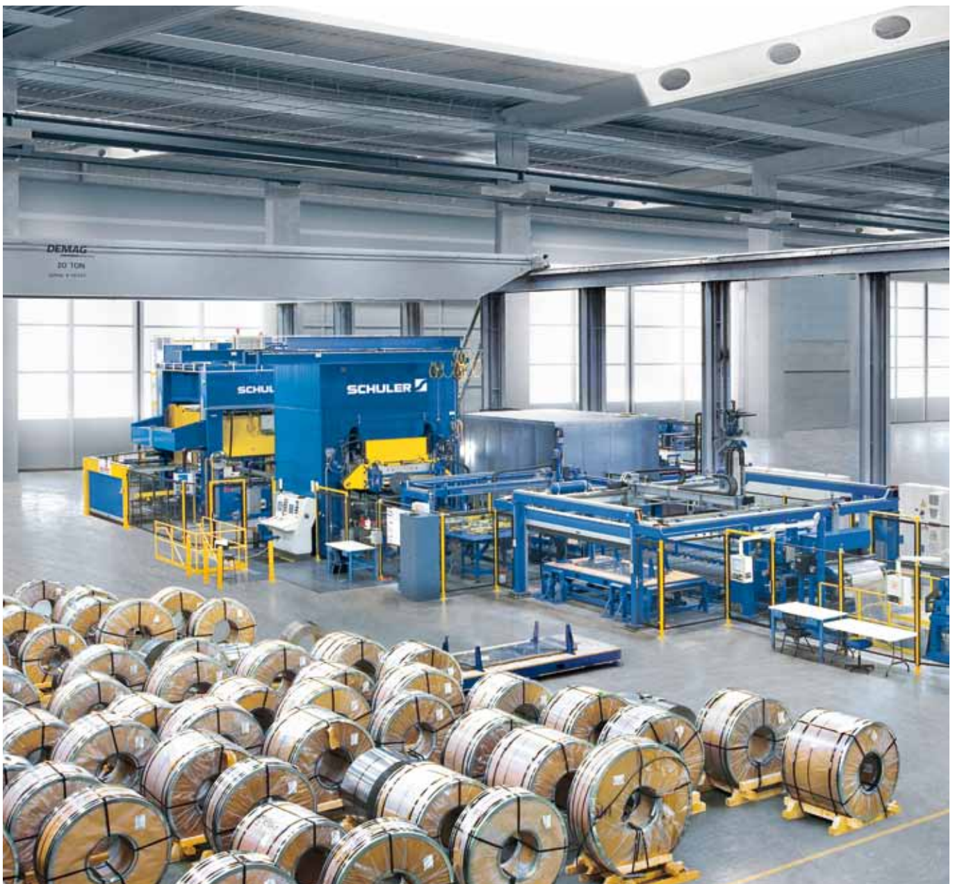
Voll automatisierte Anlage zur Herstellung von Wärmetauscherplatten.
