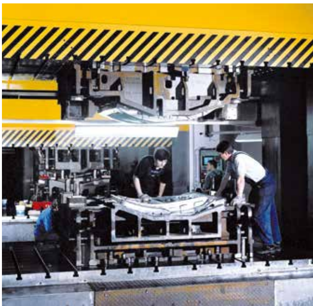
Hydraulische Tryoutpressen ermöglichen die schnelle Einarbeitung von Ziehwerkzeugen.
