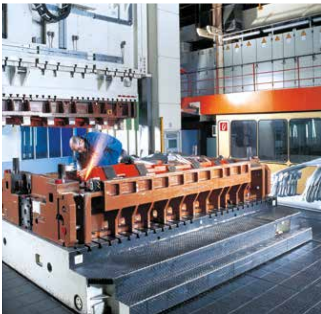
Komfortabler Werkzeugwechsel mit Fahrtischen.
