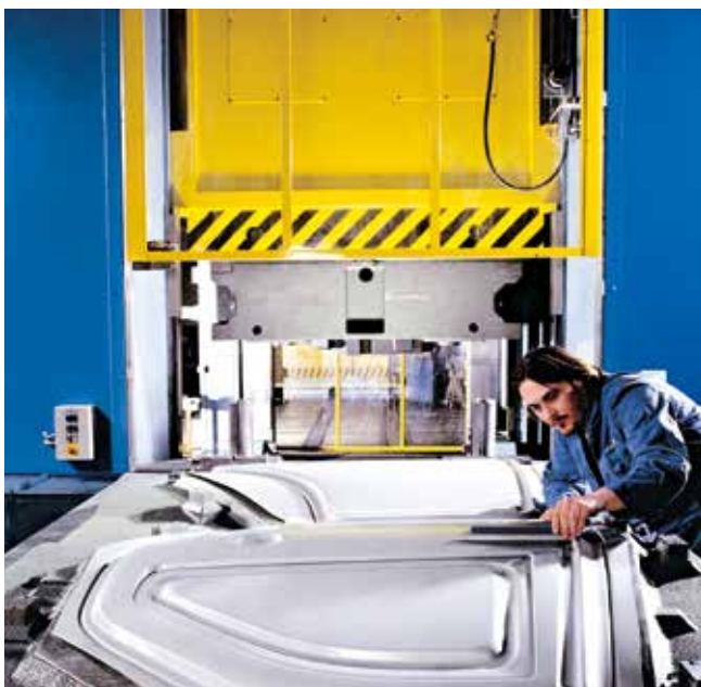
Moderne Tryoutsysteme ermöglichen die produktionsnahe Werkzeugeinarbeitung.
