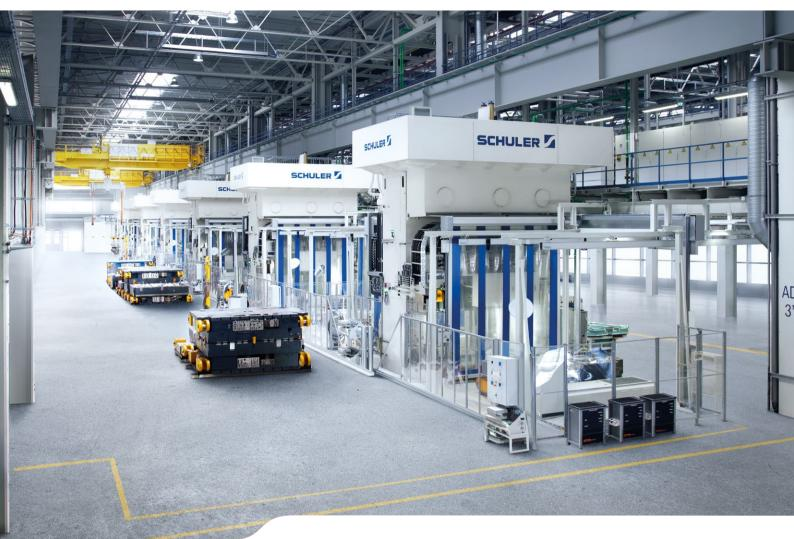
HYDRAULISCHE PRESSENSYSTEME FÜR FASERVERSTÄRKTE KUNSTSTOFFE
