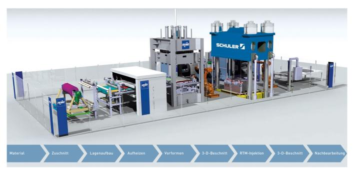
Modulares Baukastensystem: Fertigungslinie für RTM-Bauteile.
