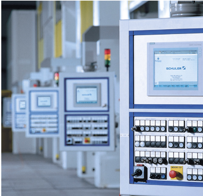
Hydraulische Pressenlinien ermöglichen die voll automatisierte Produktion von der Platine zum fertigen Teil.
