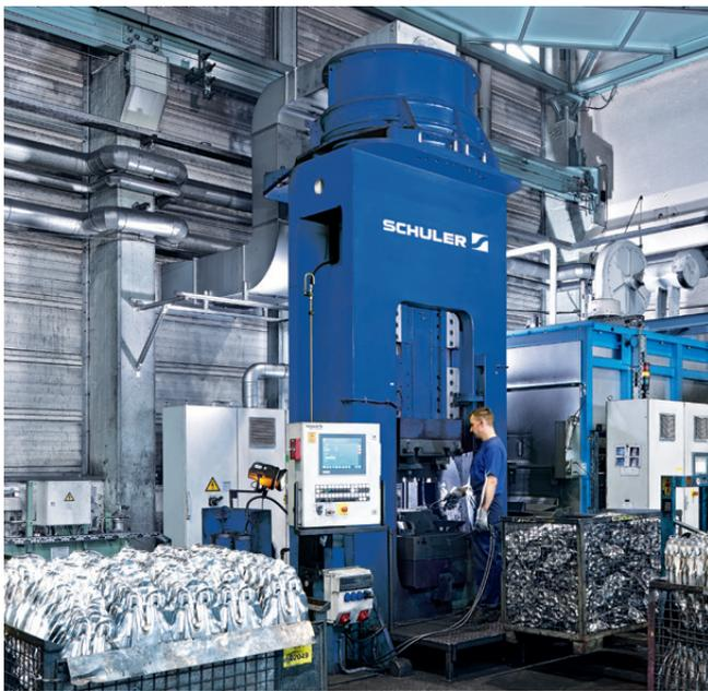
Spindelpresse Typ PAR 265f zur Herstellung von Aluminium-Schmiedeteilen.
