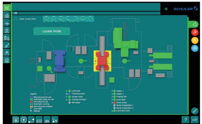
Forge-Control-System zur Überwachung der kompletten Schmiedelinie.
