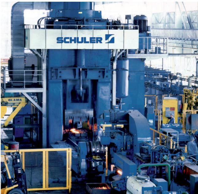
Spindelpresse Typ PSH 4.630f zur Herstellung von Teilen für leichte Lkw.
