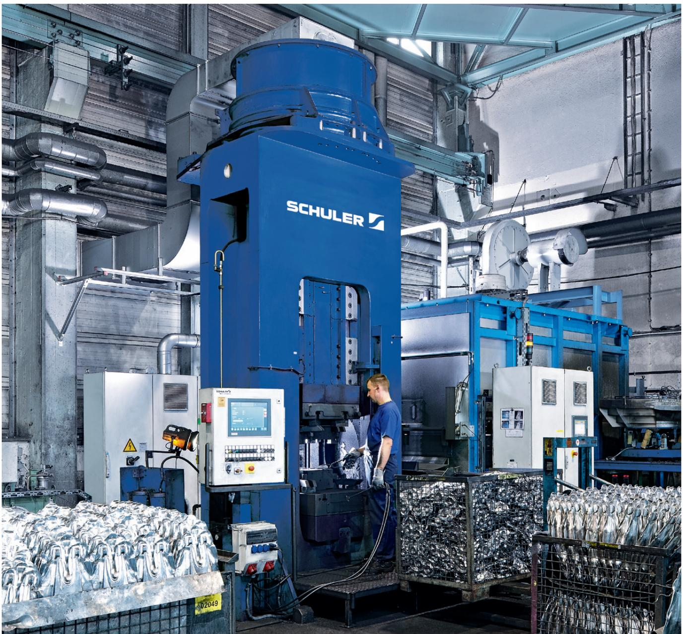
Spindelpresse Typ PAR265f zur Herstellung von Aluminium-Schmiedeteilen.
