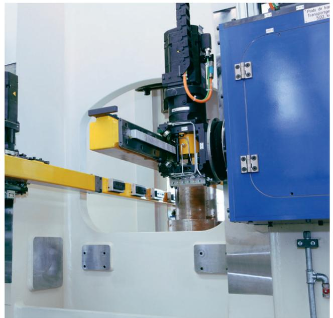
Montage des Transfers in einer Spindelpresse.
