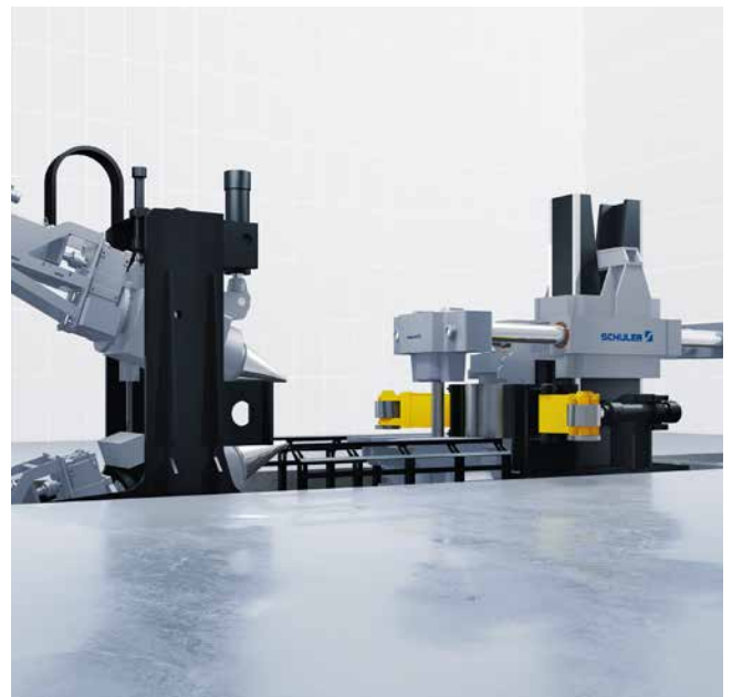
Herstellung flacher und hoher Ringe auf derselben Ringwalze.
