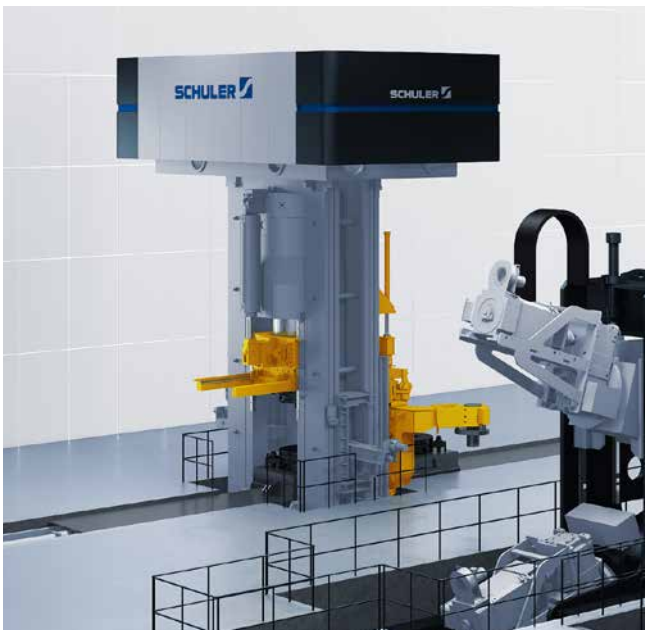
Hydraulische Presse zum Schmieden von Ringrohlings (MH-3000).
