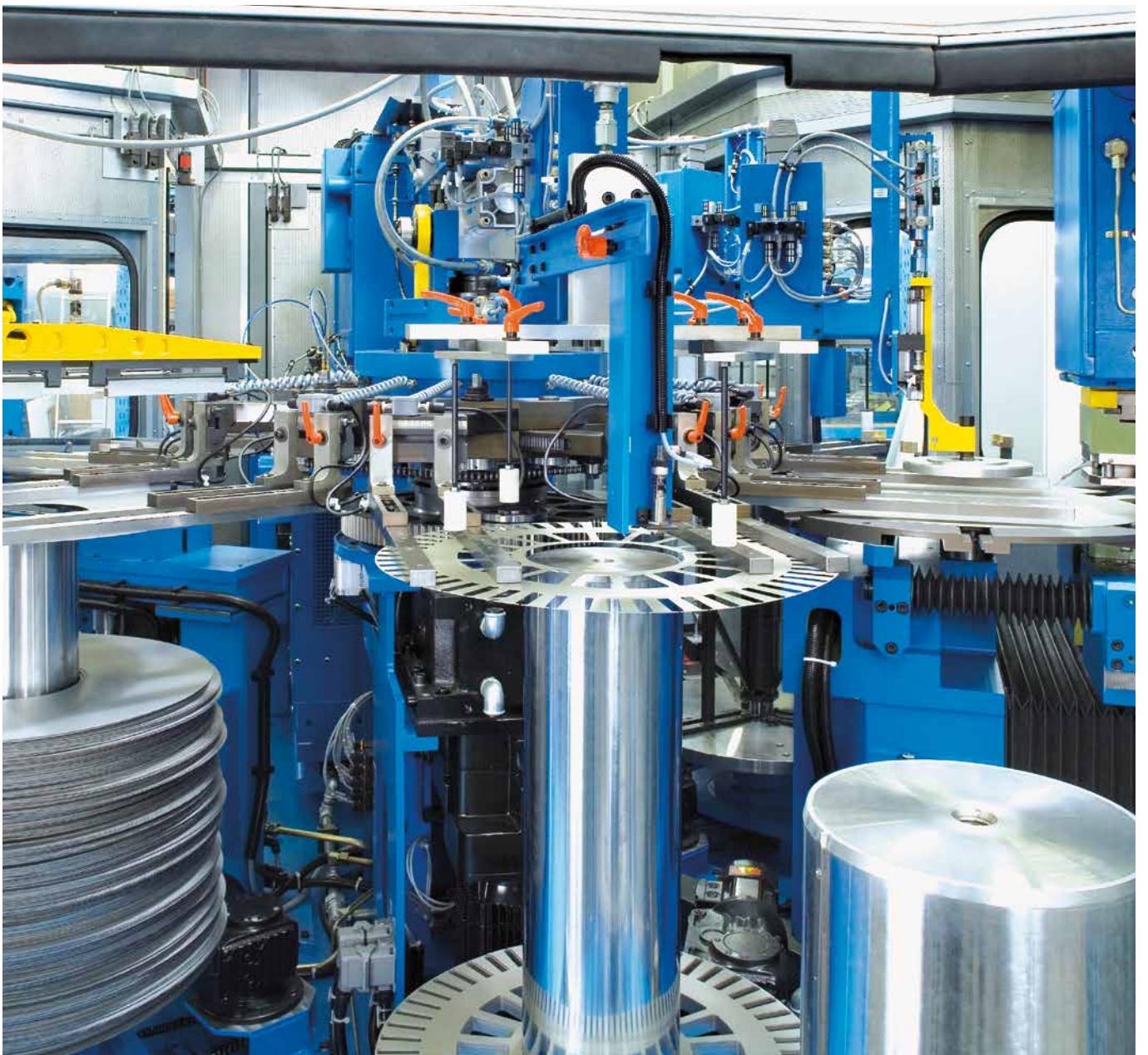
Vollautomatische Nutanlage mit Drehkreuzautomatisierung.
