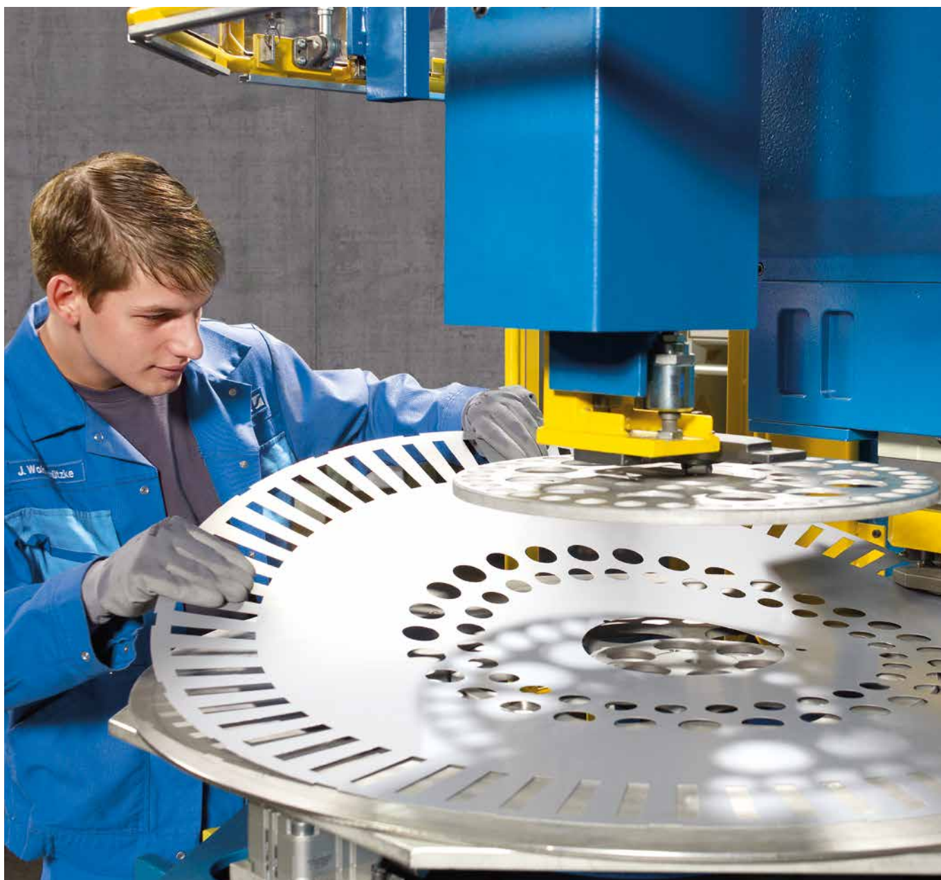
Präzise Fertigung und einfache Bedienung mit einer handbedienten Nutenstanze.
