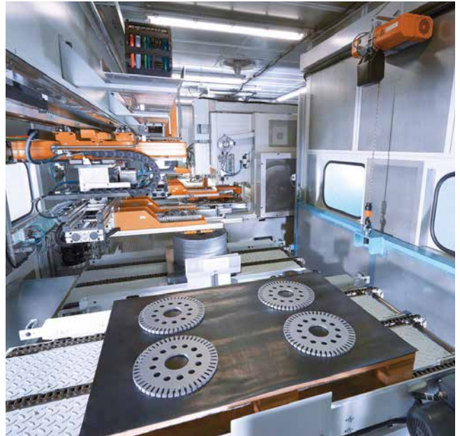
Vollautomatische Nutanlage mit Linearautomatisierung.
