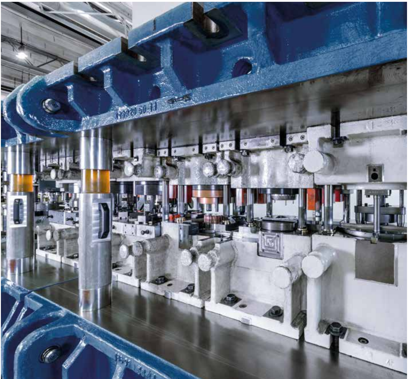
Stufenwerkzeug zur Herstellung von Lamellenträgern.
