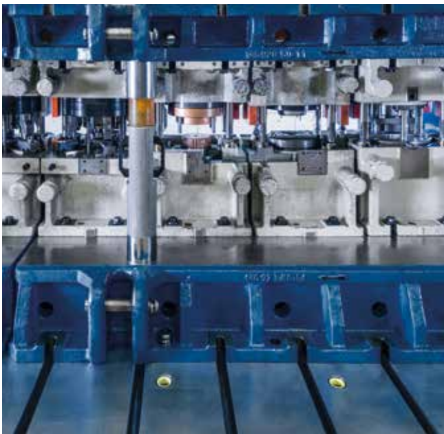
Stufenwerkzeug zur Herstellung von Lamellenträgern.
