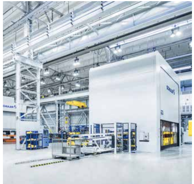
Das Presswerk in Erfurt mit drei Transferpressen.
