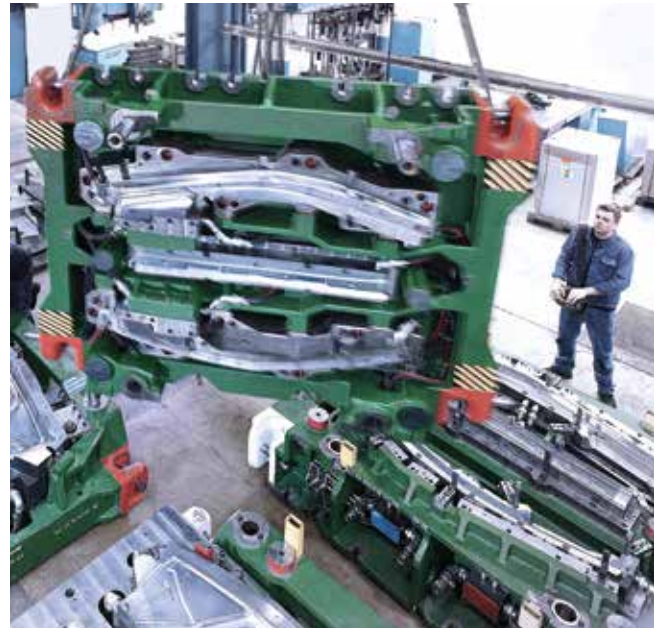
Hot Stamping Werkzeug zur Herstellung hochfester Karosserieteile.
