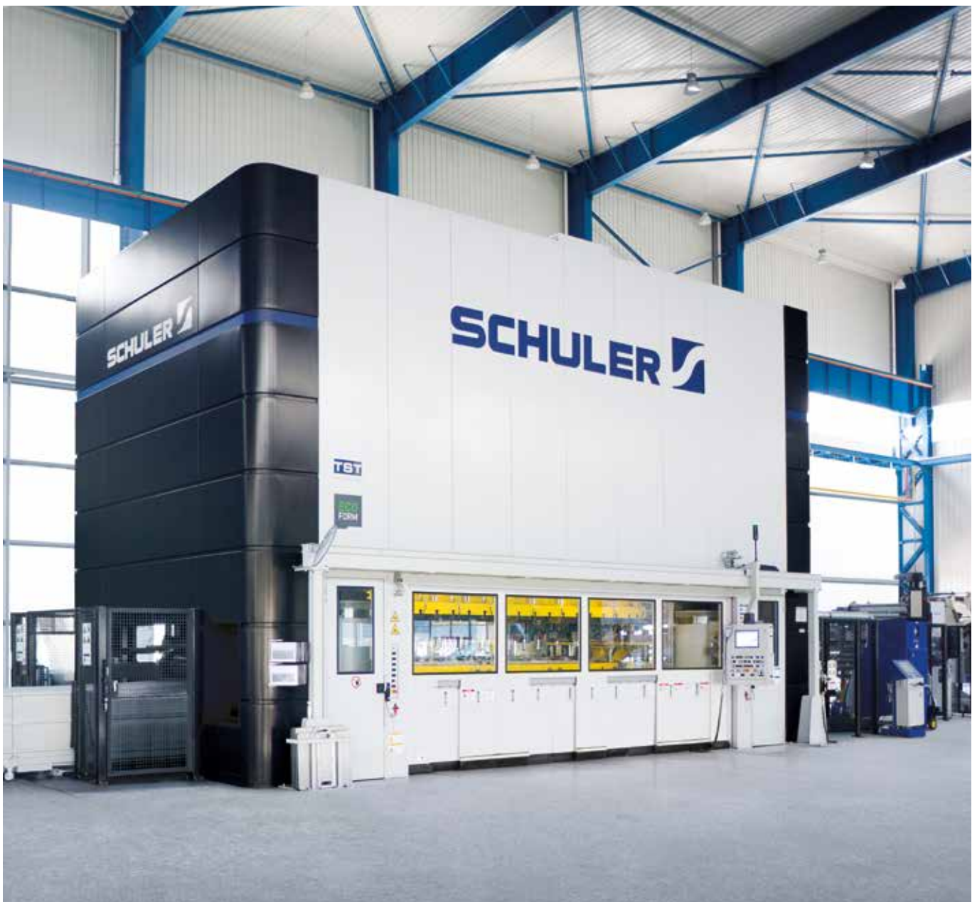
Transferpresse mit TwinServo Technologie im Schuler Servo TechCenter Erfurt.
