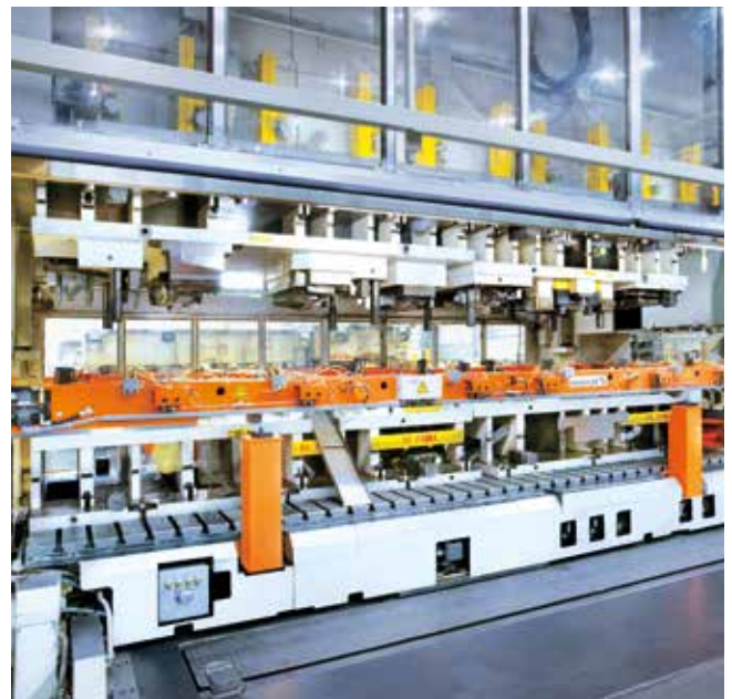
Modularer elektronischer Drei-Achs-Transfer.
