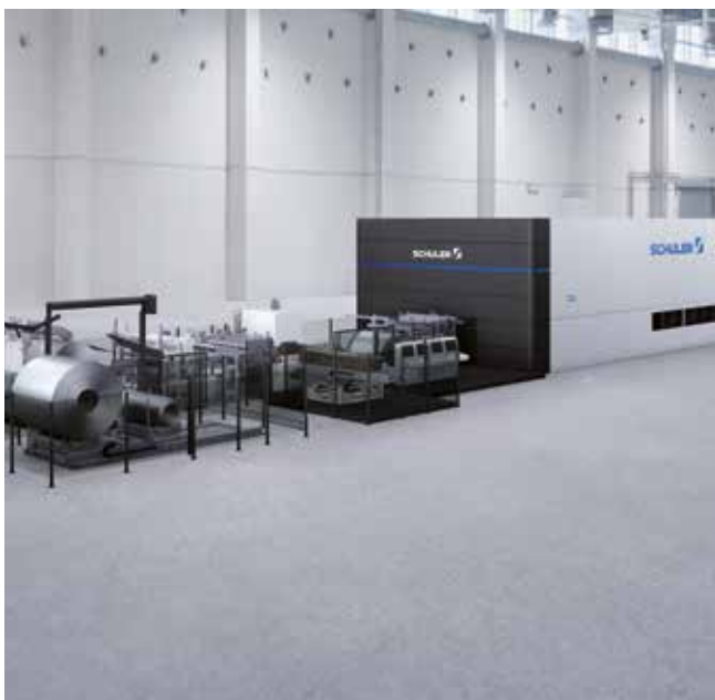
Platinenschneidanlage mit Servopresse.
