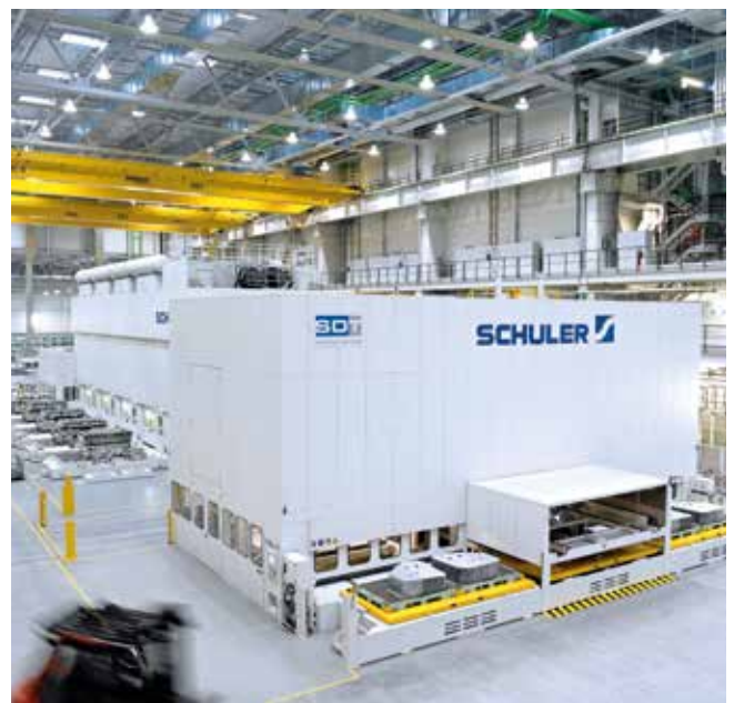
Servopressenlinie mit Platinenlader, Crossbar Feeder-Automation und End-of-Line-System.
