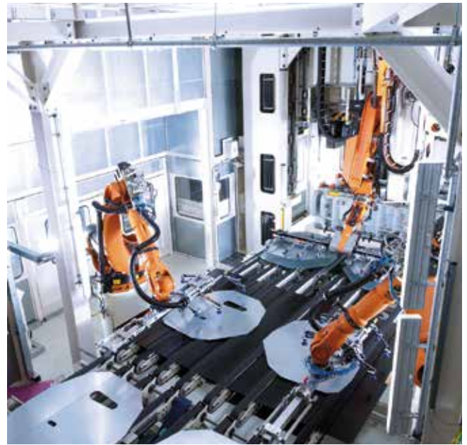
Platinenlader einer Servopressenlinie mit optischer Zentrierstation. Die Beladung der Presse 1 erfolgt durch einen Crossbar Feeder.
