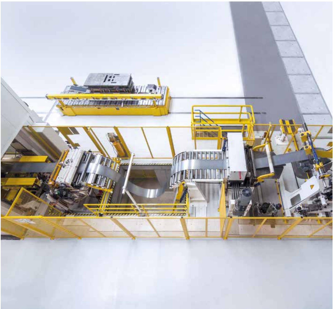
Bandzuführanlage in Langbauform mit Walzenvorschub in Zick-Zack-Ausführung für eine optimale Materialausnutzung.
