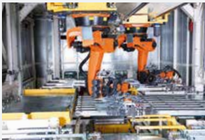
Platinenentstapelung mit Roboter.
