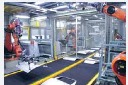
Abstapeln der fertigen Bauteile mit Robotern.
