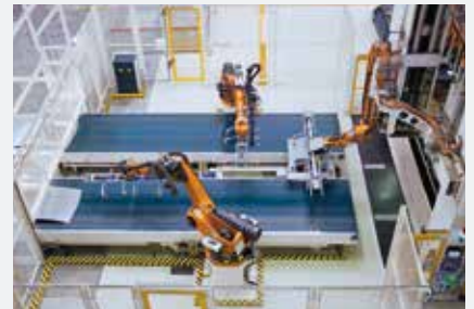
Auslaufband mit ergonomischer Teilepositionierung.
