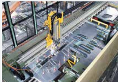
Platinenentstapelung mit Feeder.
