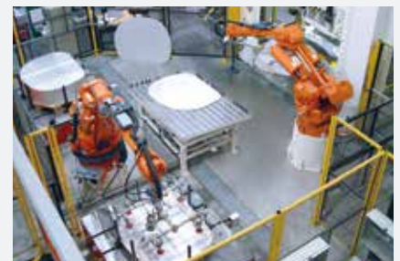
Platinenlader mit Schwerkraftzentrierstation.
