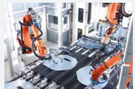
Platinenlader mit optischer Zentrierstation.
