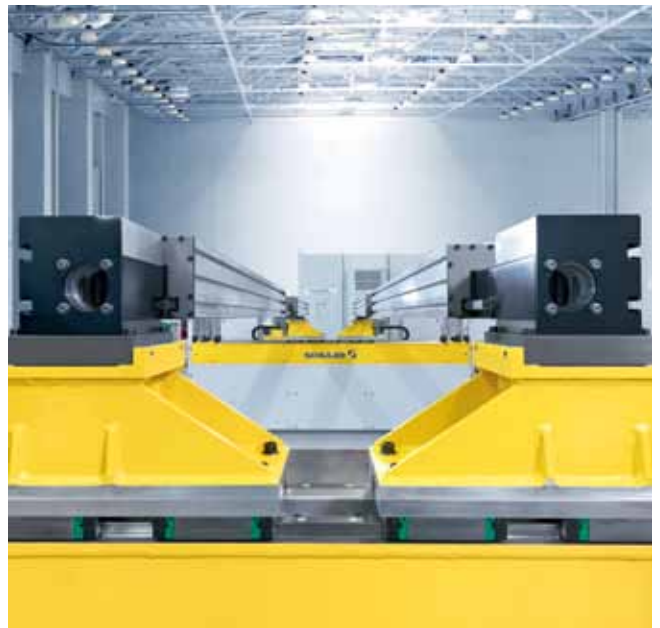
舒勒 Intra Trans 输送装置采用紧凑型设计，是级进模制造的绝佳替代方案。
