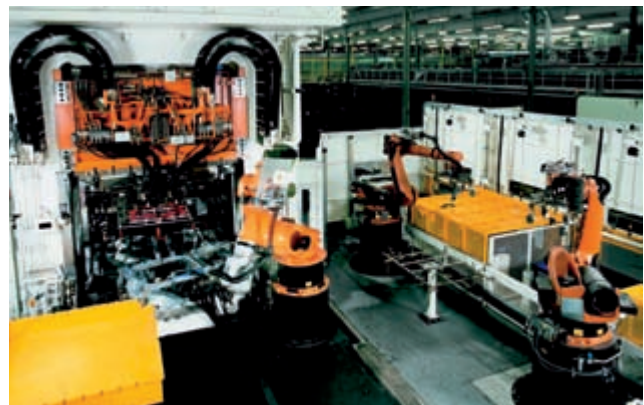
Les composants finis encore chauds sont empilés dans des containers de transport.
