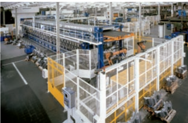
Deux robots chargent le four continu à rouleaux avec des flans ou des composants préformés.
