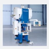
• Prensas en construccion "C" 250 – 2.500 kN
