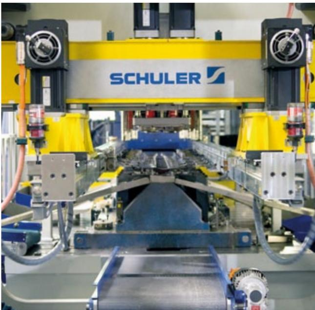
Transfer de tres ejes con accionamiento servo.
