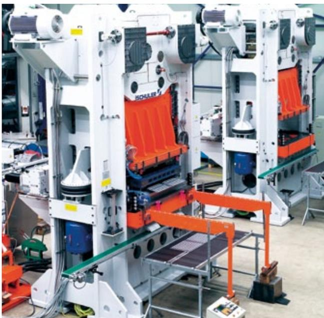
Prensa para unidades de calefacción RMK 1500 con accionamiento superior de palancas articuladas dobles.
