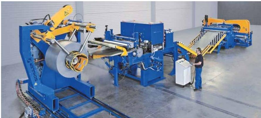
Linha de corte de platinas da Schuler para fabricação de perfis angulares.
