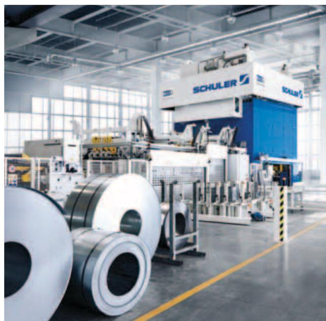
拉杆式设计伺服压力机，配有开卷送料线并采用长型设计，压力机冲压力：16,000 kN。
