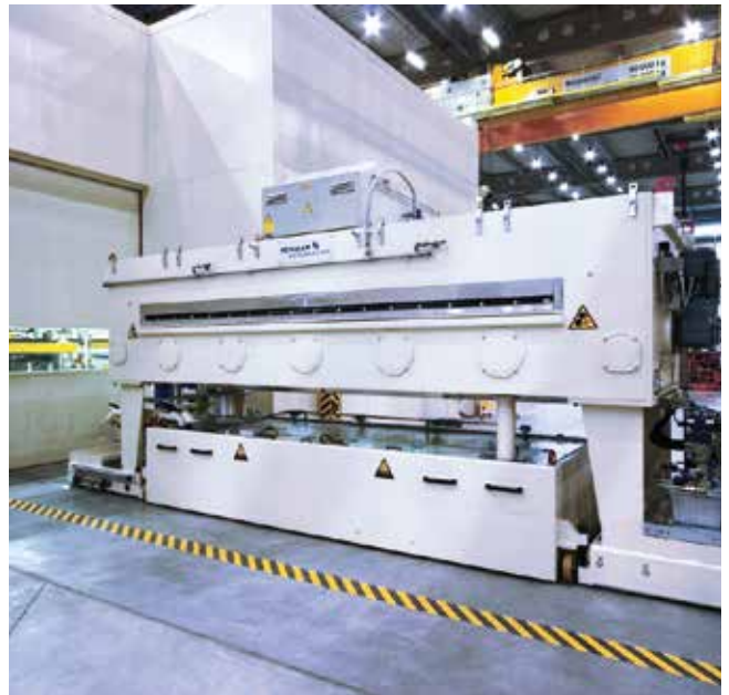
Platinenlader mit Waschmaschine.
