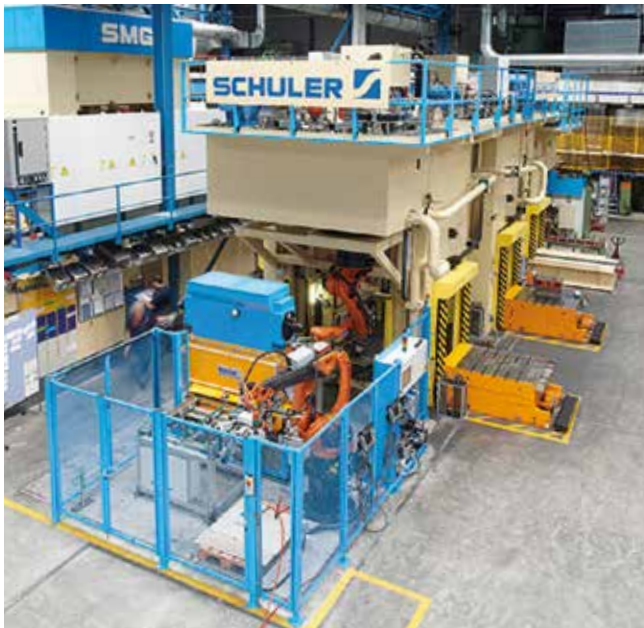
Automatisierte hydraulische Pressenlinie zur Fertigung von Edelstahlspülbecken.
