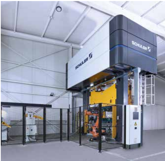
Automatisierte Fertigungszelle zur Herstellung von Automotive-Teilen.
