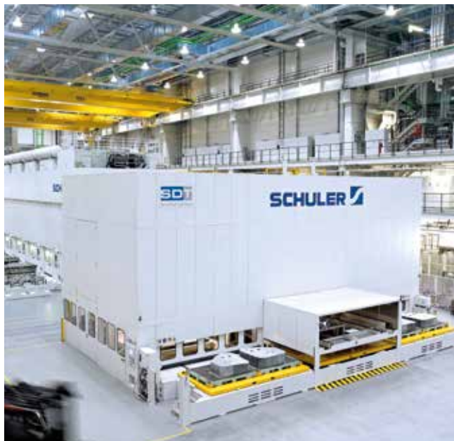
Fünfstufige Pressenlinie mit ServoDirekt Technologie und Crossbar Feeder-Automation.
