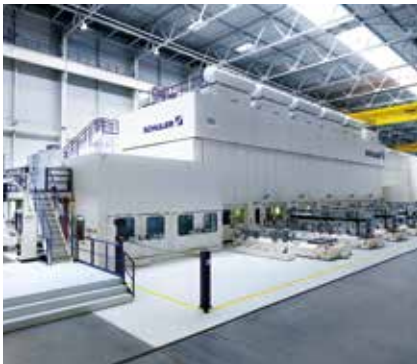
ServoLine 23 L mit sechs Werkzeugstufen.
