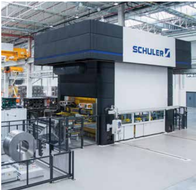
Servopresse in Zugankerbauweise.
