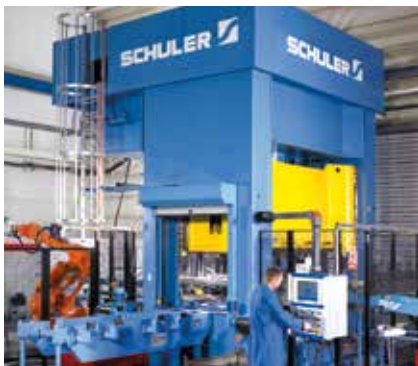
Hydraulische Presse zur Fertigung von Seitenschwellern und Dachspiegeln.
