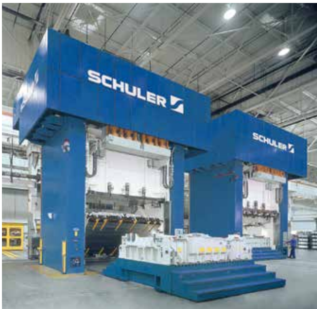
Multicurve-Pressen mit Fahrtisch und Werkzeugwendevorrichtung.
