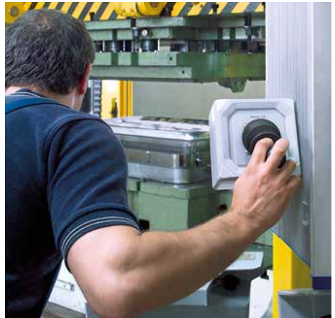
Der Stößel kann mittels Joystick feinfühlig auf und ab gefahren werden.
