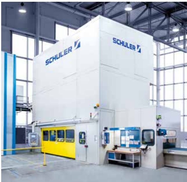
Hydraulische Transferpresse. Presskraft: 25.000 kN.
