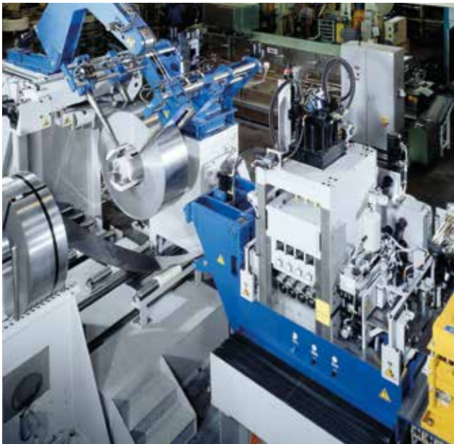
Bandzuführanlage in Kurzbauf orm.
