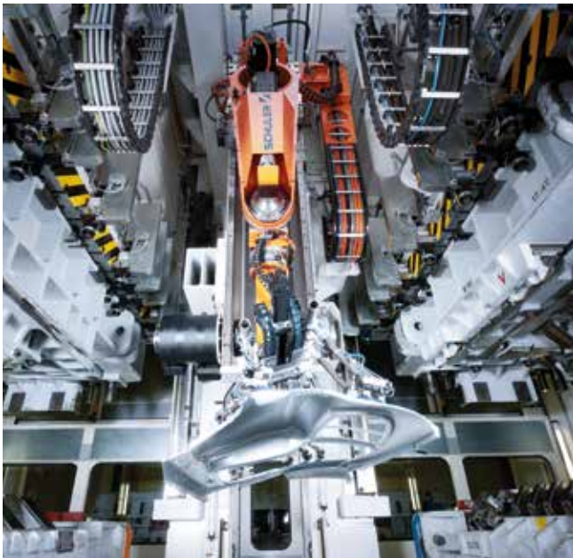
Crossbar Feeder innerhalb der Pressenlinie.
