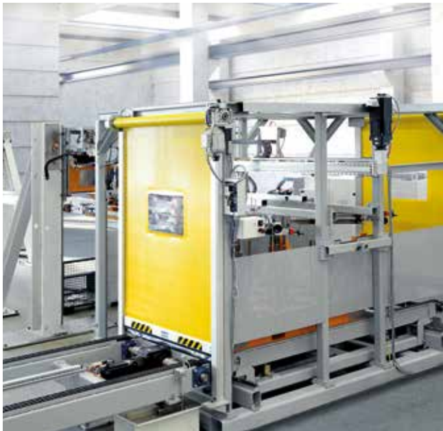
Platinenlader mit Transfersystem zum Entstapeln der Platinen.
