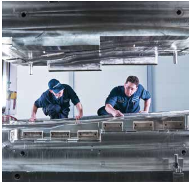
Innenhochdruckumformung von Dachrahmen.
