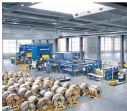
Vollautomatisches Fertigungssystem zur Herstellung von Wärmetauscherplatten.
