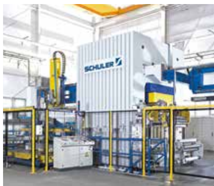
Hydraulische Prägepresse. Presskraft: 25.000 kN.
