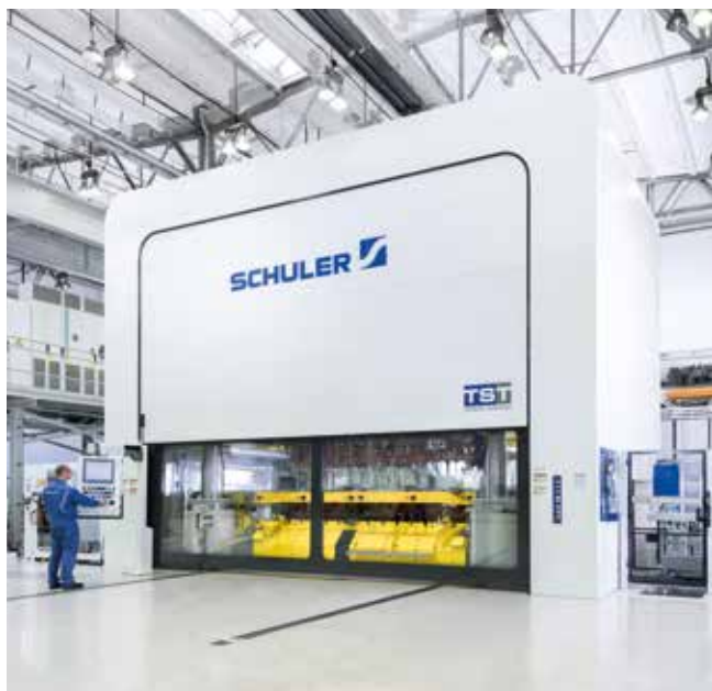
Transferpresse mit TwinServo Technologie im TechCenter Erfurt.
