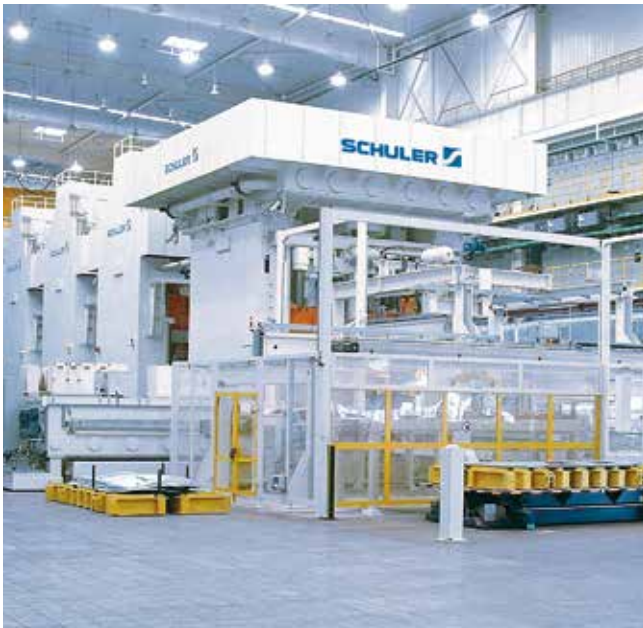
Hybridpressenlinie mit hydraulischer Kopf- und mechanischen Folgepressen.
