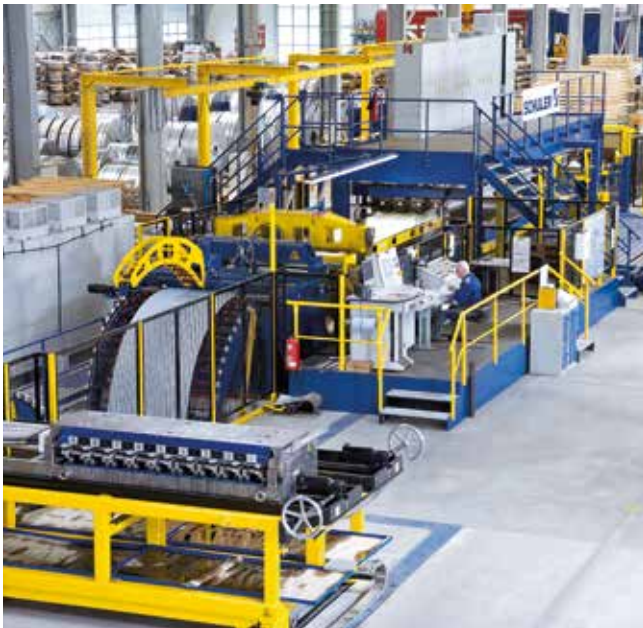
Platinenschneidanlage mit Querteilschere.
