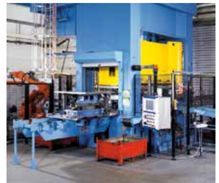
Halbautomatischer Werkzeugwechsel in 15 Minuten.
