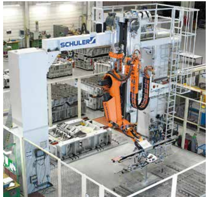
Simulatoreinrichtung für Crossbar Feeder.
