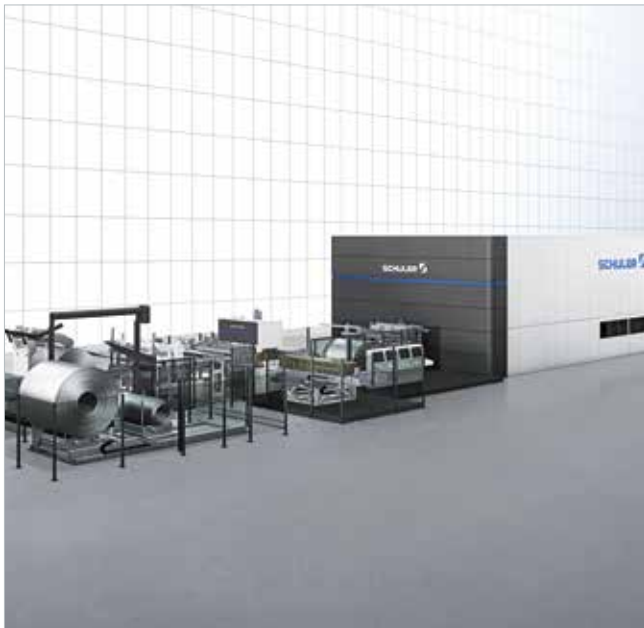
Platinenschneidanlage mit Servopresse.
