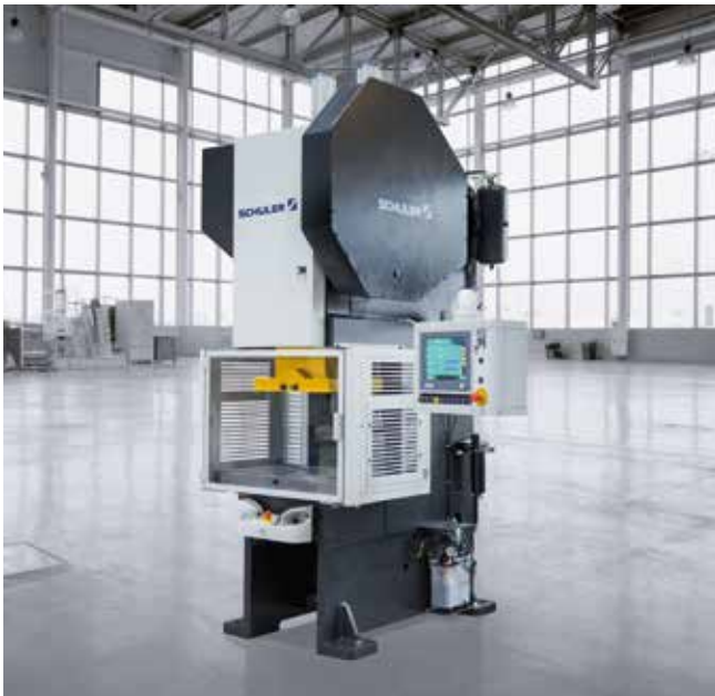
C-FLEXline 630 kN mit Touch-Panel.
