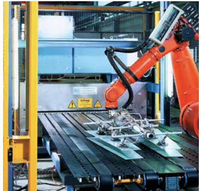
Beladeroboter positionieren die Platinen passgenau im Werkzeug der ersten Presse.
