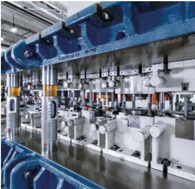
Transferwerkzeug für die Herstellung präziser Getriebeteile.
