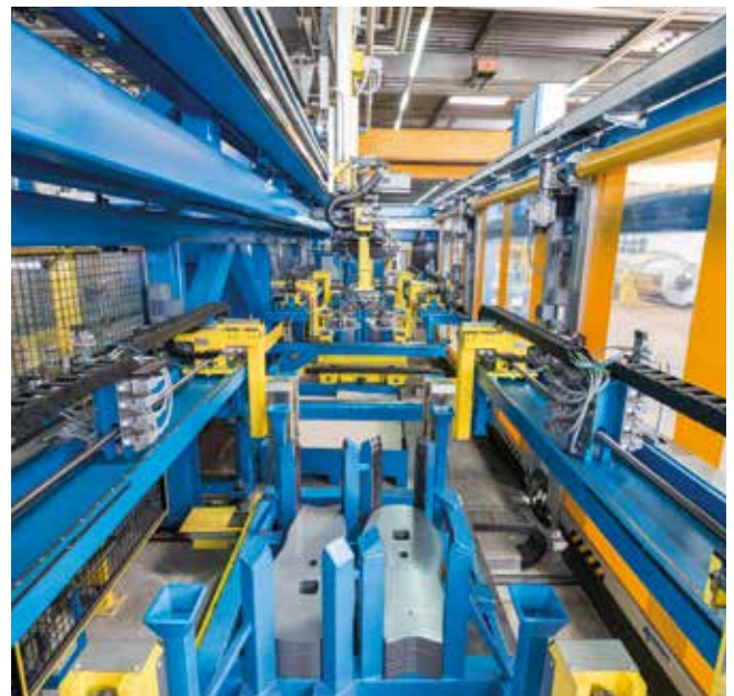
Feeder-Beladestation mit Platinenvereinzlung.
