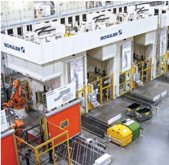
Hydraulische Pressenlinien zur Herstellung von Aluminiumbauteilen.
