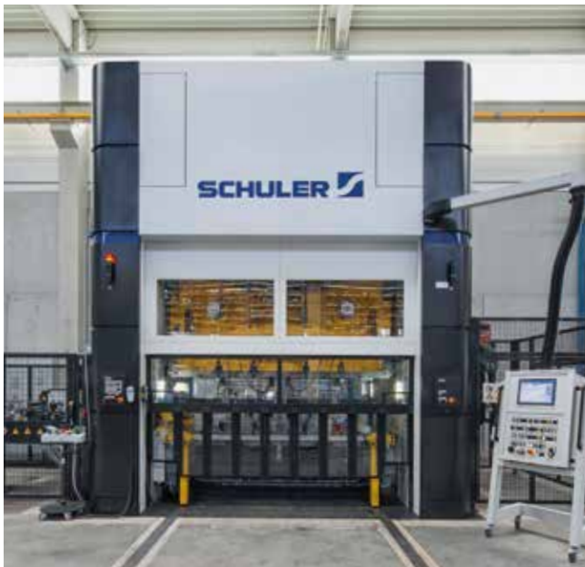
Servopresse in Monoblockbauweise mit 400 kN Presskraft.
