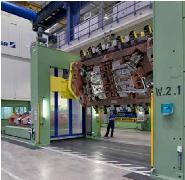
Werkzeugwender zum einfachen Drehen von Oberwerkzeugen.
