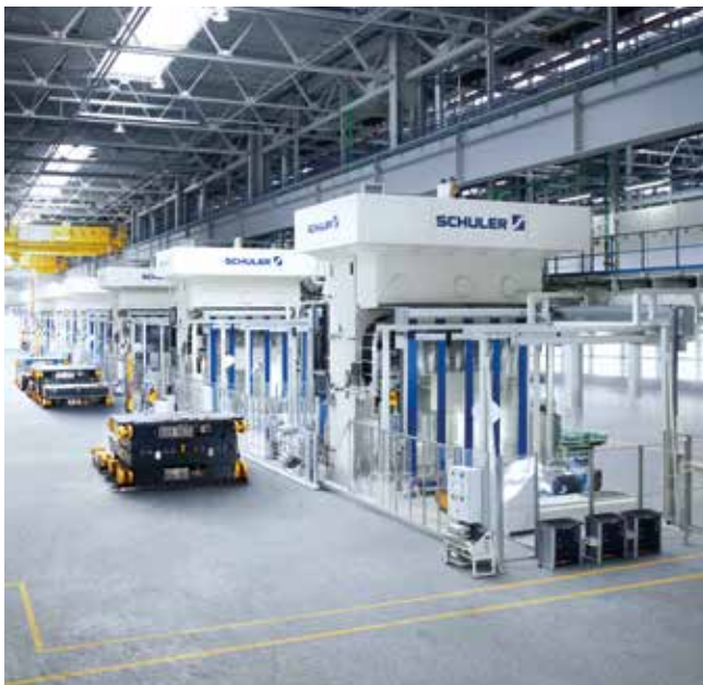
Hydraulische Kunststoffpressen für die Serienfertigung.
