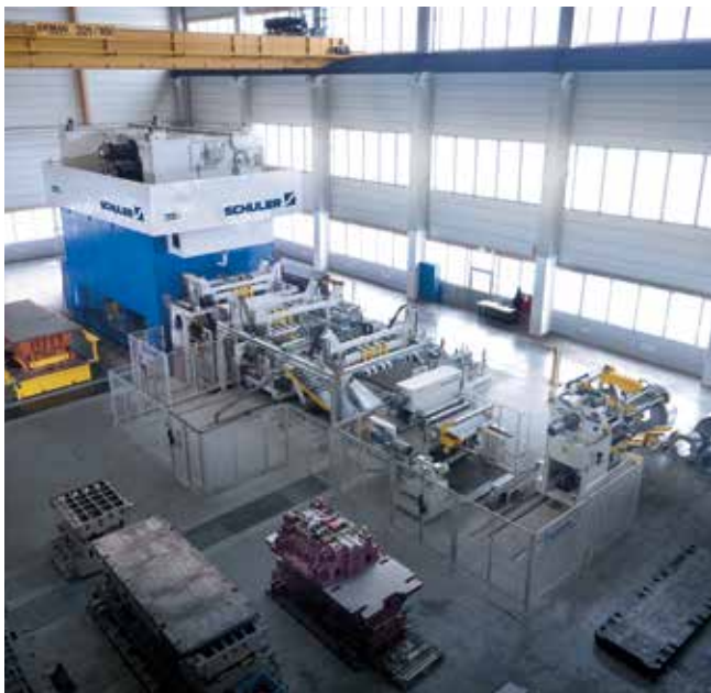
ServoDirekt-Pressen zur Kaltumformung hochfester Stähle.
