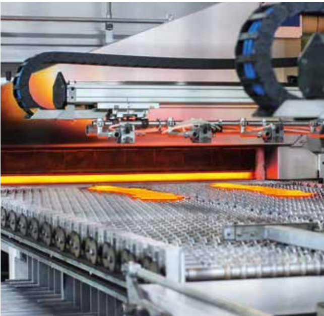
Formhärten von Sicherheitsteilen in Großserie.
