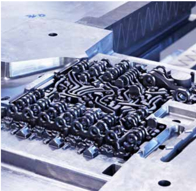
Druckgießform für ein Ventilgehäuse.
