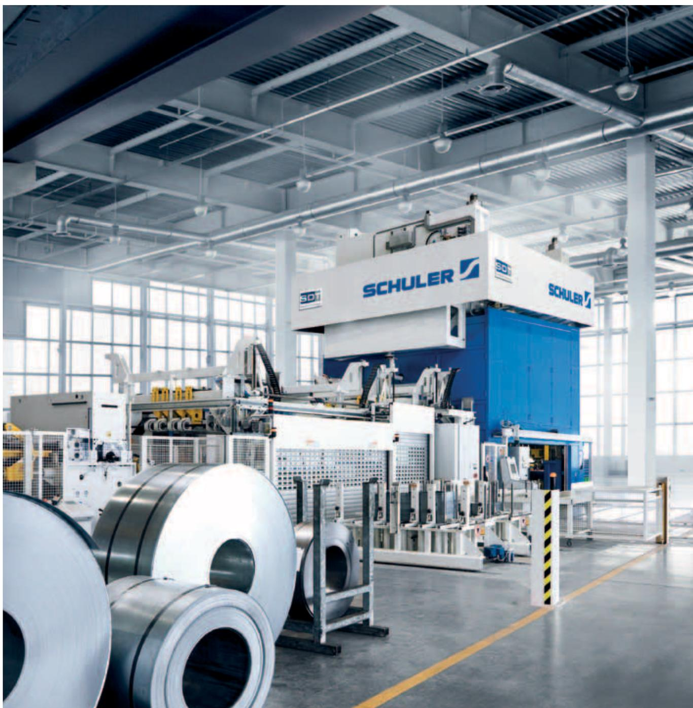
采用伺服直驱技术的多工位压力机。
