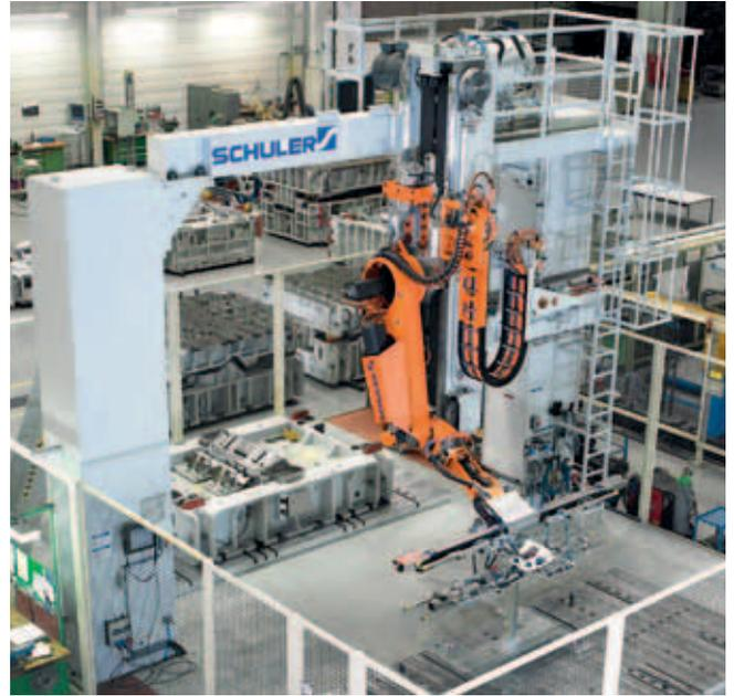
横杆式送料机械手的模拟器装置。
