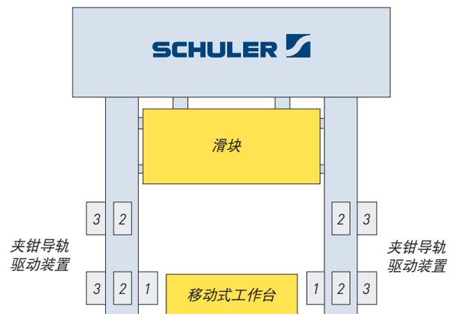
舒勒输送系统的夹钳箱可以安装在压力机立柱上的这些位置。
