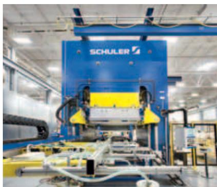
液压式压印压力机。冲压力：250,000 kN。
