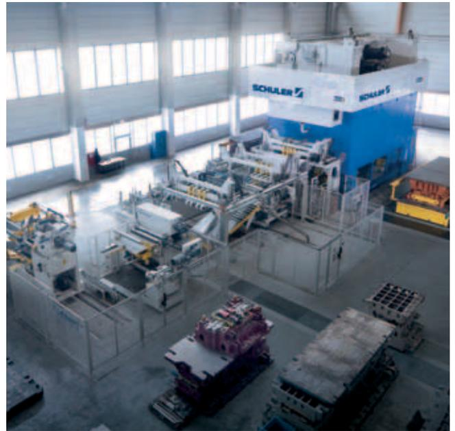
拉杆式设计伺服压力机，冲压力可达 16,000 kN，配有卷料送料线和拆垛机的组合装置。
