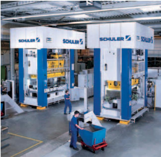
整体式设计伺服压力机。冲压力：4,000 kN。
