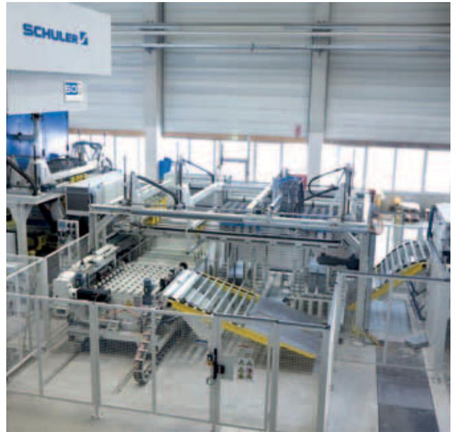
一体式系统解决方案。伺服压力机上的拆垛机和卷料线。冲压力：16,000 kN。
