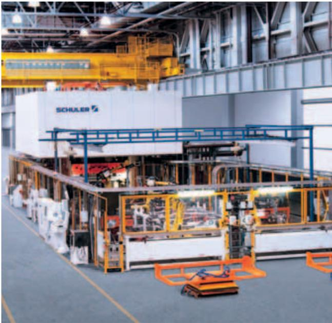
美国某汽车制造商厂房中的自动管状液压成形设备。
