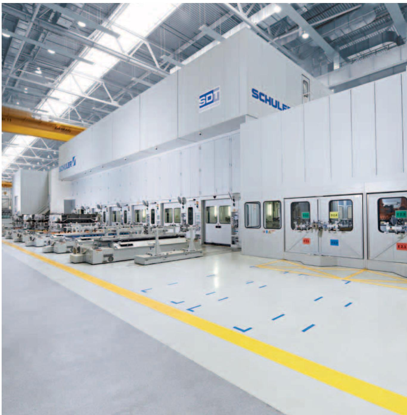
ServoLine23 L 冲压线：世界上速度最快的冲压线，产出率可达 23 冲次/分钟。
