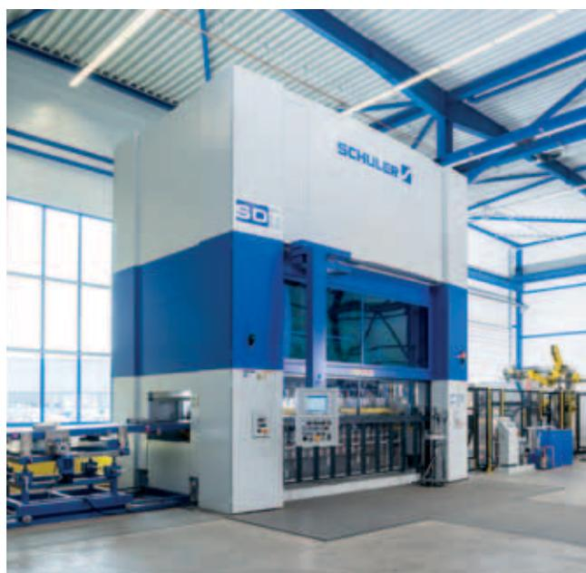
莱内斯塔特 ProTec 工艺和技术中心的 MSD 630 伺服压力机，配有创新型 Intra Trans 输送装置。
