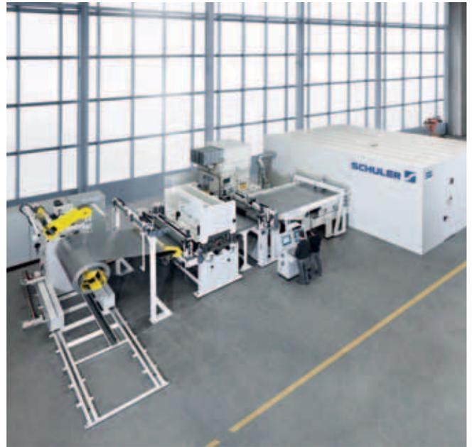
配备激光落料的开卷落料线。
