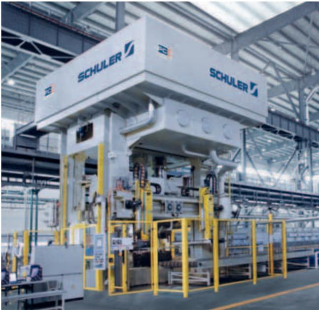
采用创新型 PCH 工作台拉伸垫理念的全自动冲压硬化生产线。
