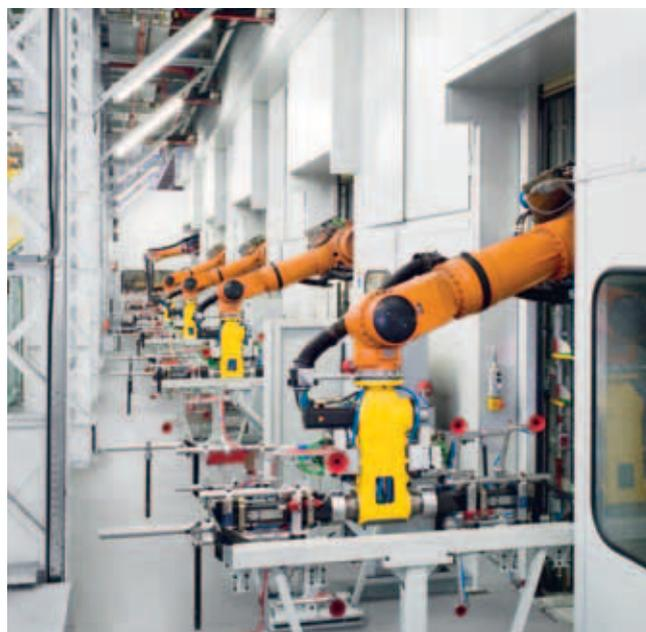
配有横杆机器人的压力机自动化装置。
