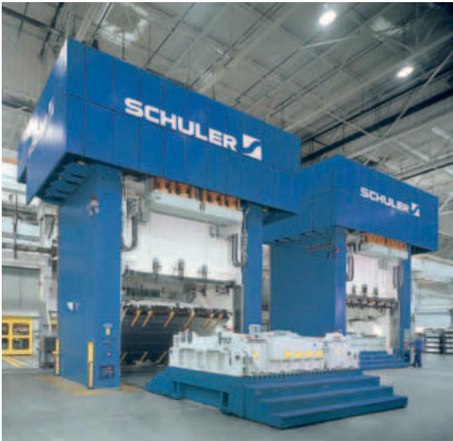
配备移动式工作台和模具翻转装置的多曲线压力机。
