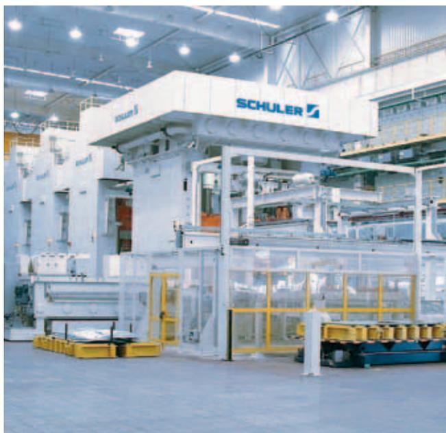
由打头液压式压力机和后续机械式压力机构成的混合式冲压线。
