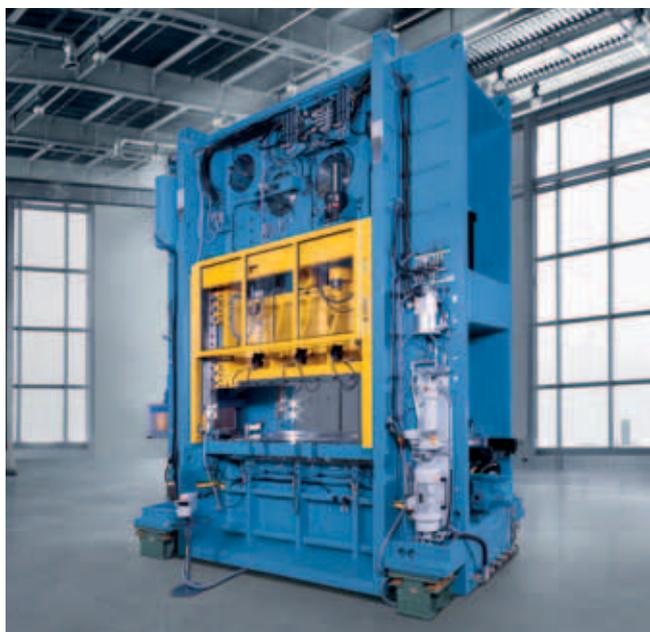
用于高精度冲裁和成形工艺的伺服驱动肘杆式压力机，
