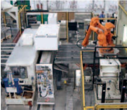
料片清洗机、涂油机和上料机器人位于液压式冲压线之前，用于制造铝质零部件。
