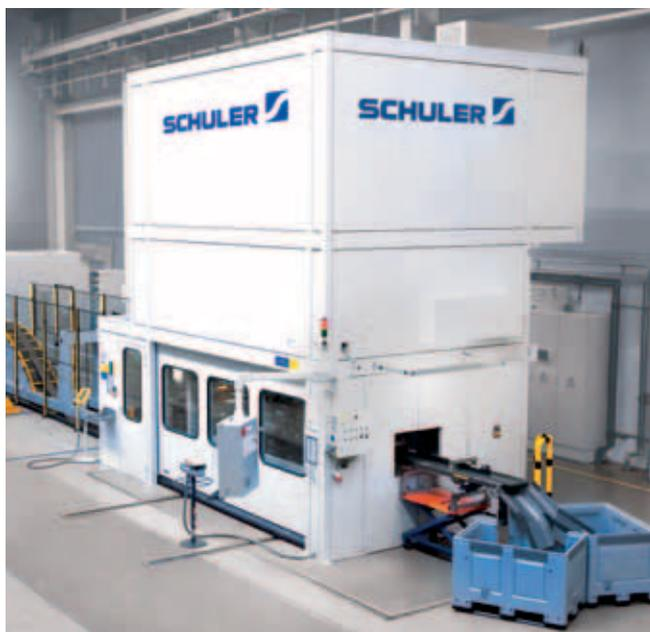
伺服驱动肘杆压力机。冲压力：8,000 kN。
