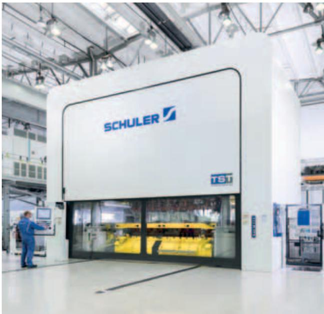
埃尔福特技术中心内采用双伺服技术的多工位压力机。
