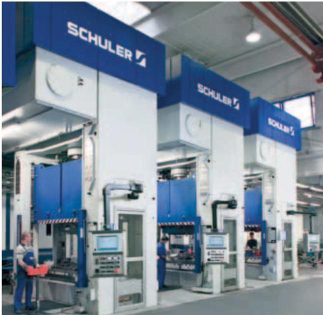
用于制造不锈钢槽的液压式压力机。
