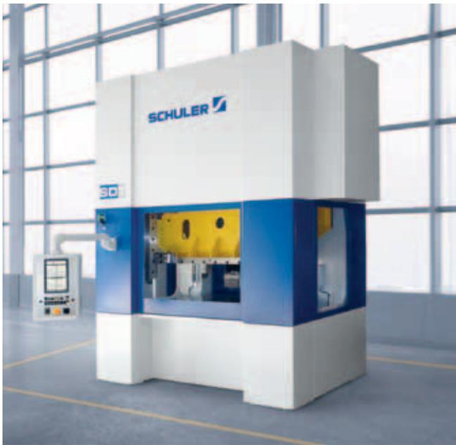
MSC-2000 自动落料压力机，冲压力可达 2,000 kN。
