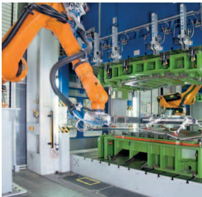
配有机器人自动化装置的冲压线。
