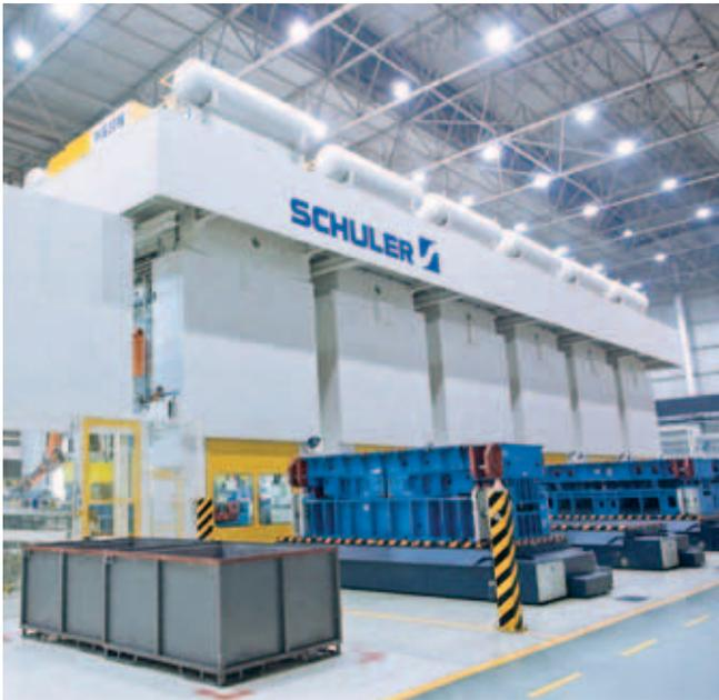
机械式高速冲压线。
