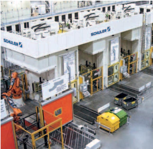
用于铝质零部件制造的液压式冲压线。
