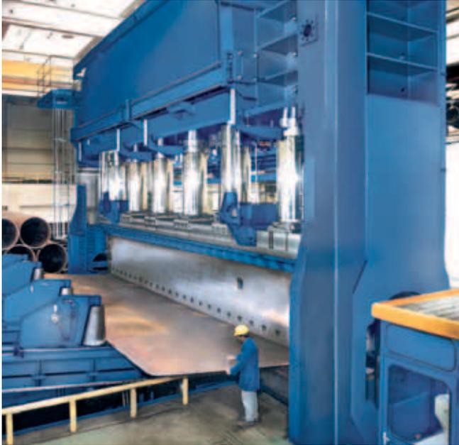
直缝焊钢管压力机。
