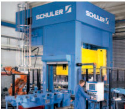
用于制造侧梁板和顶板梁的液压式压力机。
