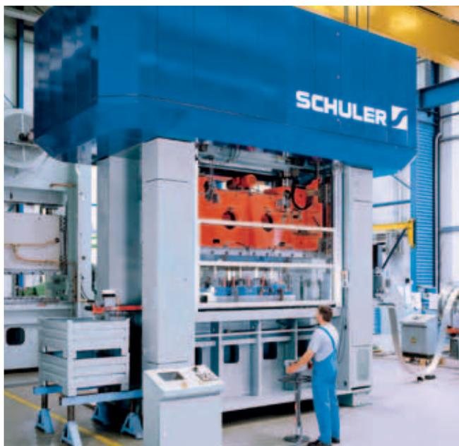
功能多样的肘杆式压力机易于操作、换模简便 - 可实现高水平的利用率和效率。
