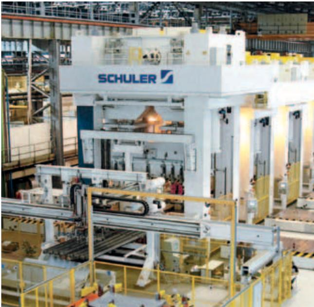
配有横杆式自动化机械手的机械式高速冲压线。
