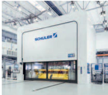
采用双伺服技术的多工位压力机。冲压力：16,000 kN。
