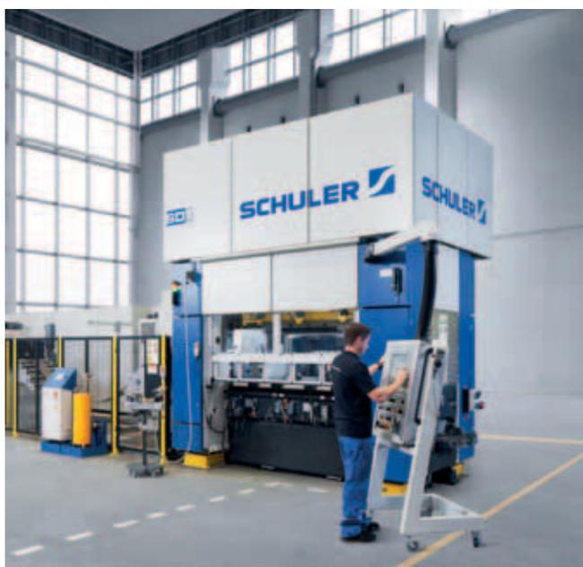
格平根伺服技术中心的 MSD 250 伺服压力机 - 专为满足冲压操作的各种需求而设计。
