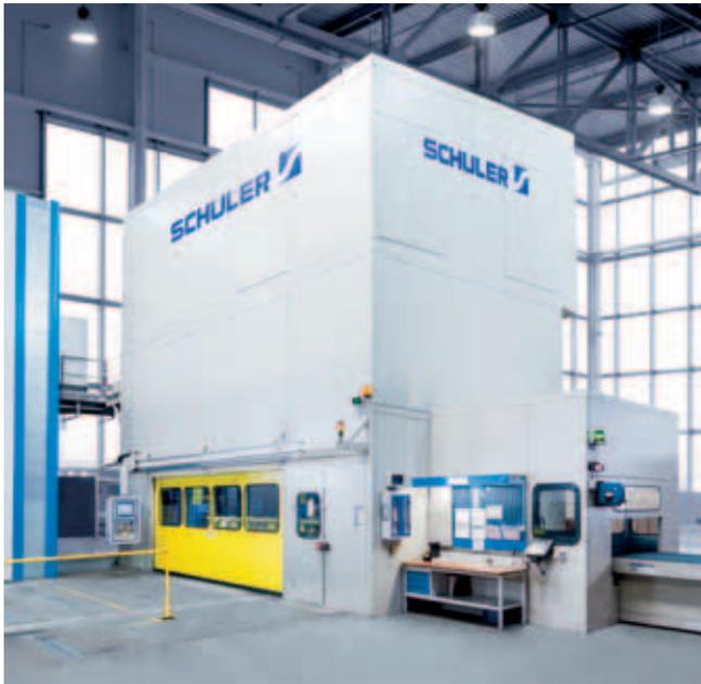
多工位液压机。冲压力：25,000 kN。
