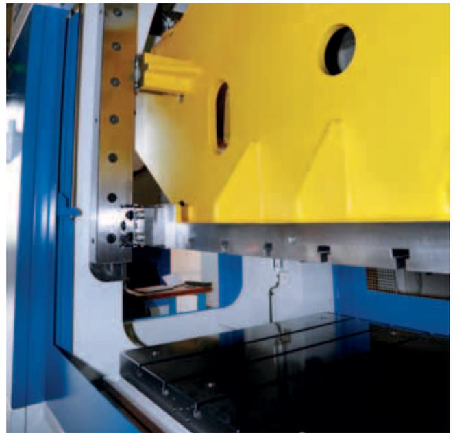
预紧式 12 向滑块导向装置，实现零磨损。
