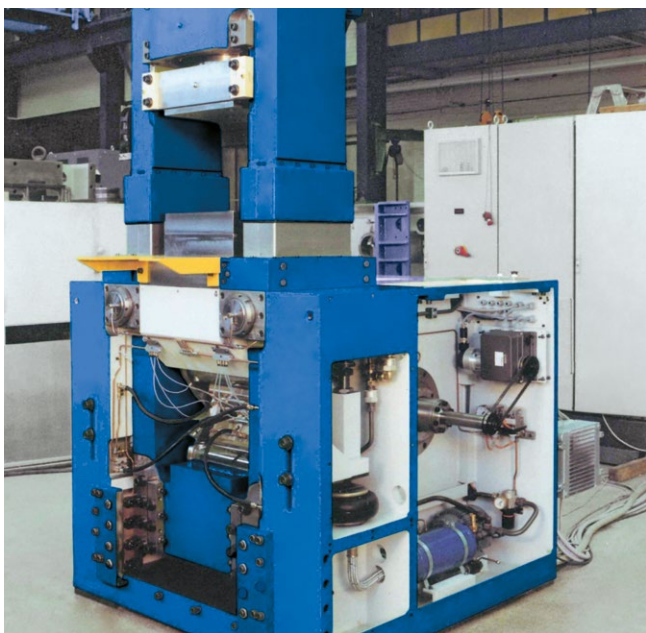
EMK 630 mit Kniehebel-Untertrieb.
