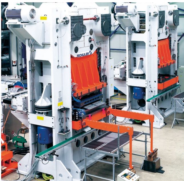
Heizkörperpresse RMK 1500 mit Doppelkniehebel-Oberantrieb.
