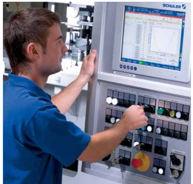
操作员正在对滑块运动曲线进行编程。
