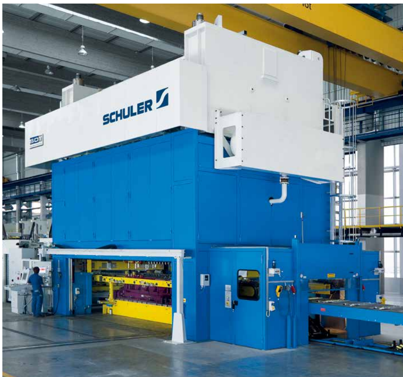
某汽车零部件供应商厂房中正在生产一模两件零部件。冲压力：16,000 kN。
