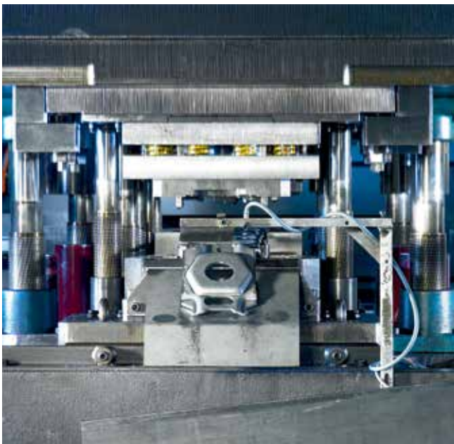
采用整体式设计伺服压力机进行量产，冲压力：6,300 kN。
