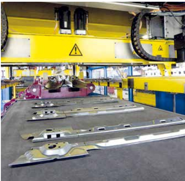
采用拉杆式伺服压力机进行量产，冲压力：16,000 kN。
