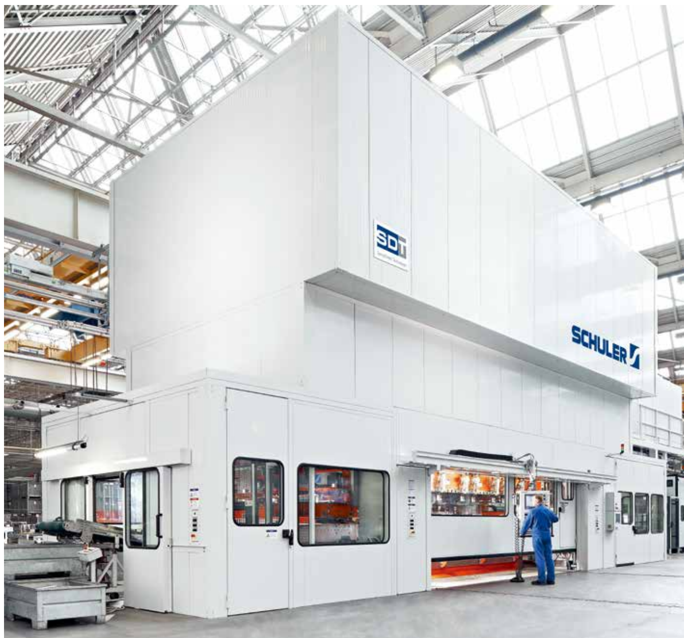
某家用电器制造商厂房中的拉杆式设计伺服压力机。冲压力：16,000 kN。
