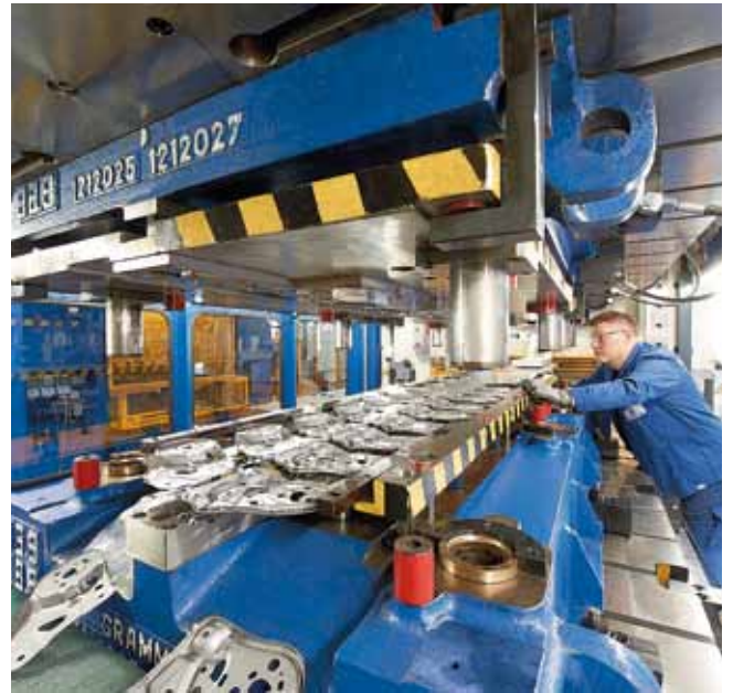
采用拉杆式伺服压力机进行量产，冲压力：8,000 kN。
