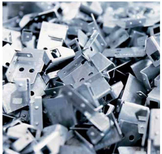
采用整体式设计伺服压力机进行冲压量产，冲压力：2,500 kN。
