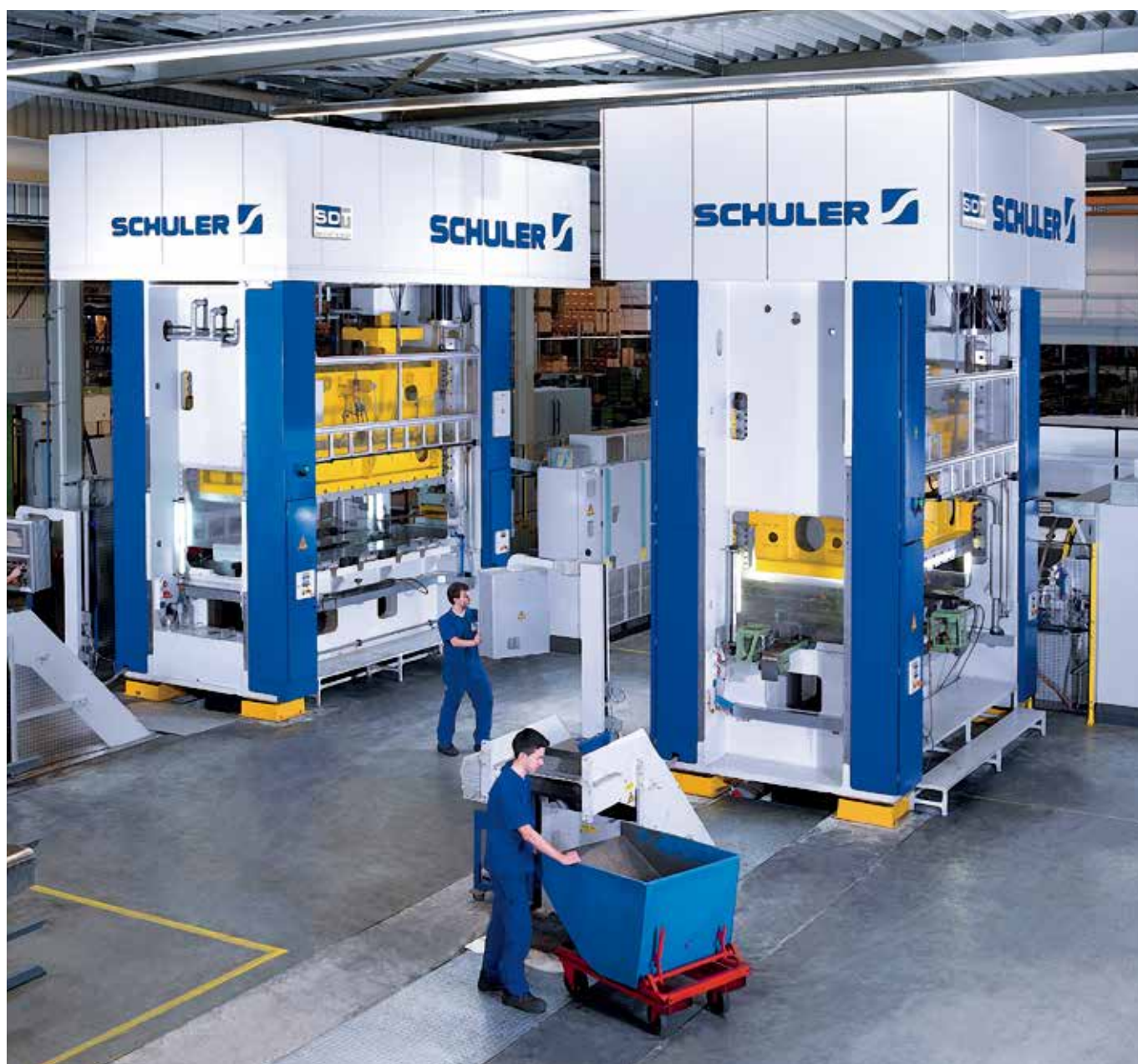
采用整体式设计伺服压力机进行灵活生产。冲压力：4,000 kN。
