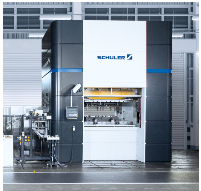
Servopresse in Monoblockbauweise MSP 400.
