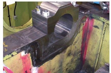
» Schweißnähte kerbarm verschliffen und Lagendurchmesser fertig bearbeitet.
