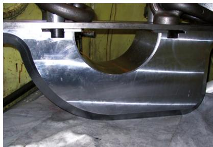
» Einschweißen eines neuen verstärkten und kraftfußoptimierten Lagers.
