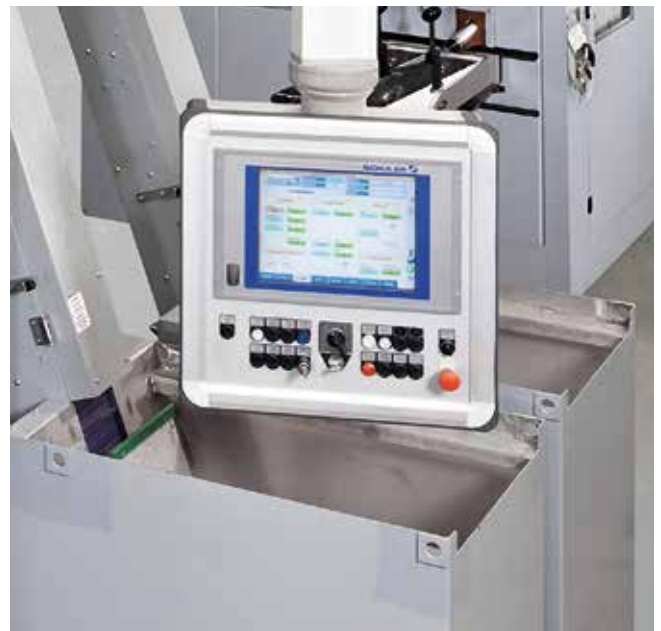
Steuerpult mit Touch-Oberfläche.
