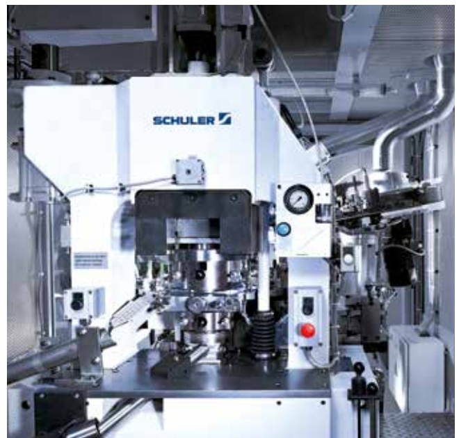
Innenansicht einer vertikalen Münzprägepresse MRV 150, ausgestattet mit Ringmaster.
