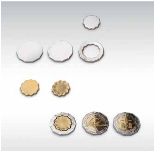
Herstellung einer unrunder Bimetall-Münze mit dem Ringmaster.
