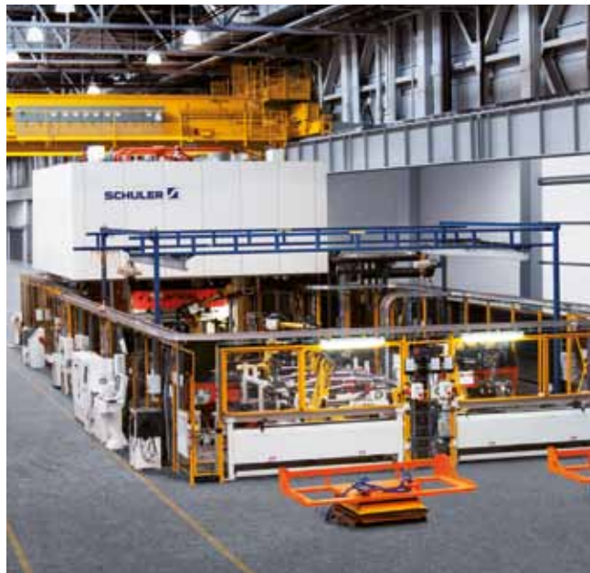
自动液压成形生产线。
