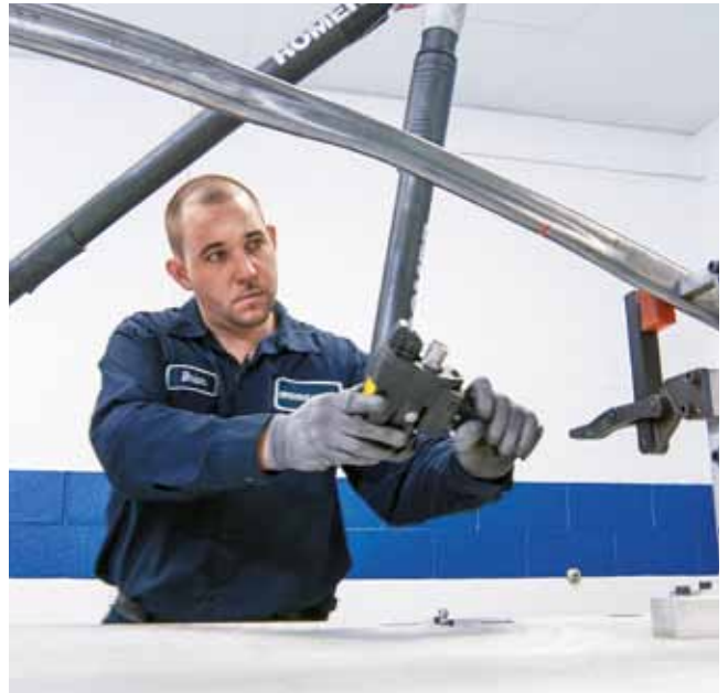
在零部件研发过程中进行激光扫描。
