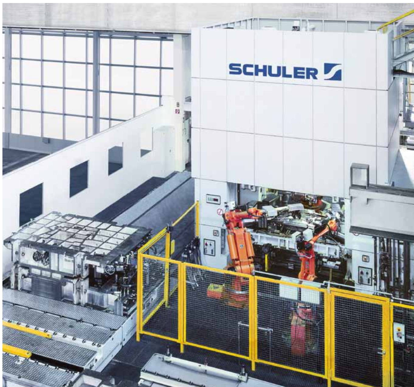
一家德国汽车制造厂的全自动管状液压成形系统。
