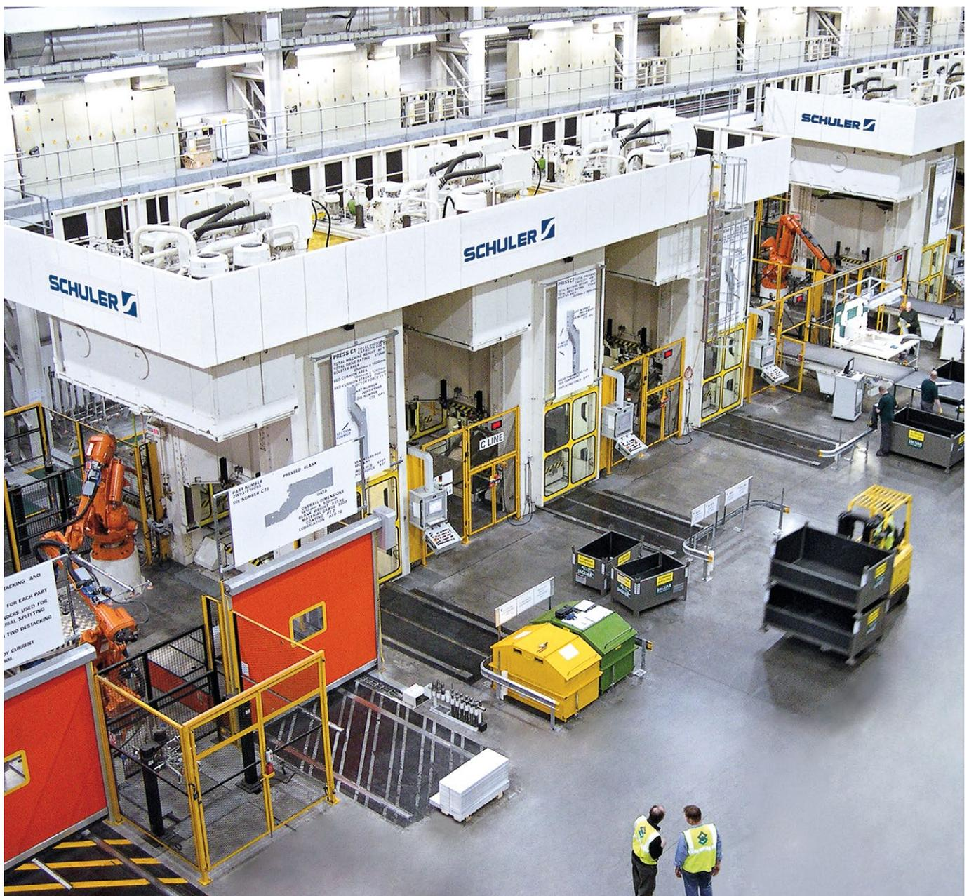
Hydraulische Pressenlinien zur Herstellung von Aluminiumbauteilen.
