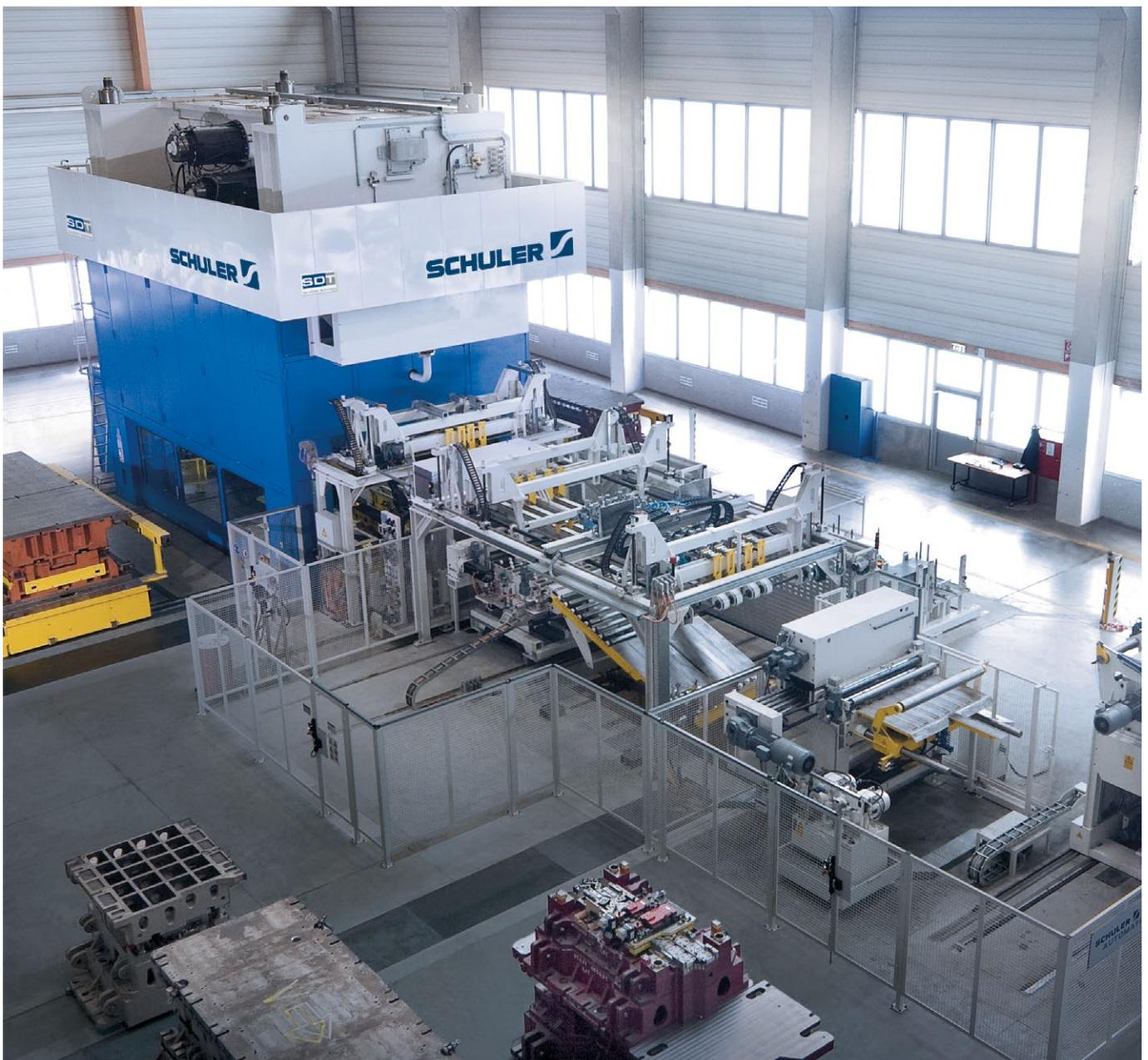
Servopresse in Zugankerbauweise mit Platinenlader-Bandanlagen-Kombination.
