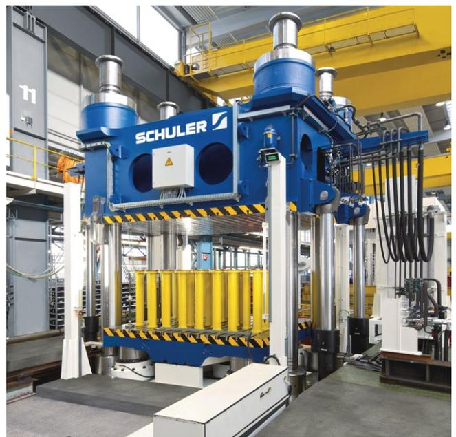
Hydraulische Kurzhubpresse zur Verarbeitung faserverstärkter Kunststoffe.
