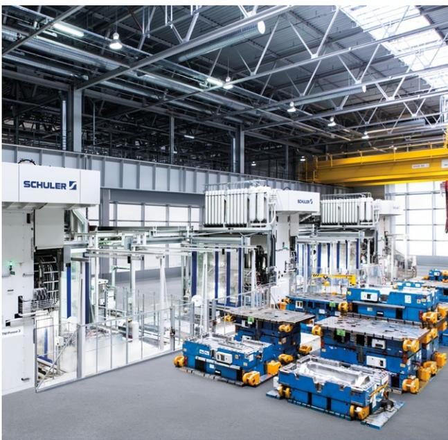
Hydraulische Kunststoffpresse für die Großserienfertigung.
