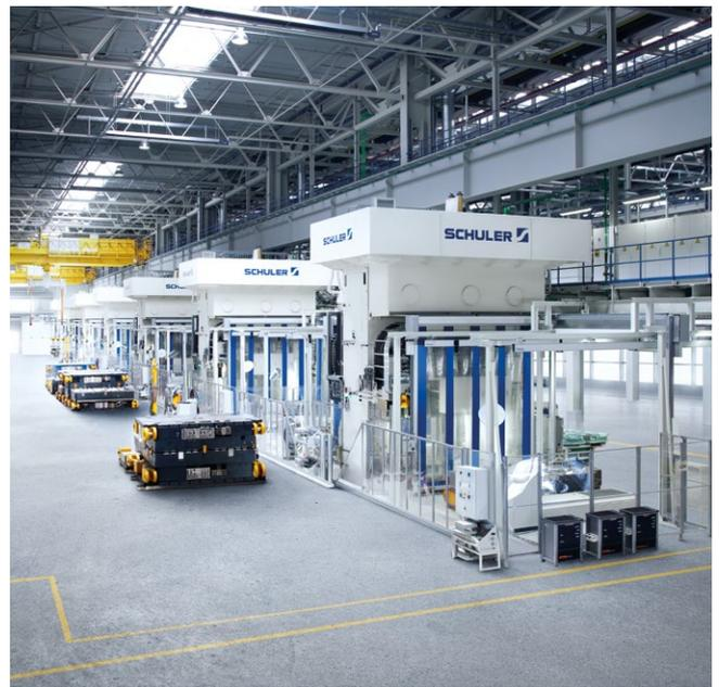
Hydraulische Kunststoffpressen für die Großserienfertigung.
