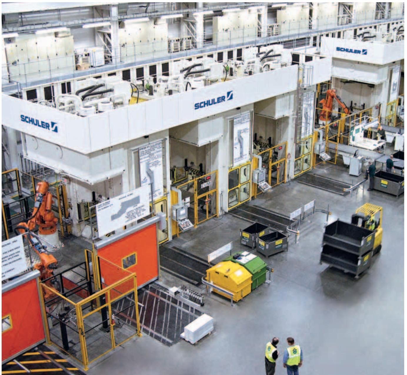
配有机器人自动化装置的液压式冲压线，适用于铝制部件的制造。
