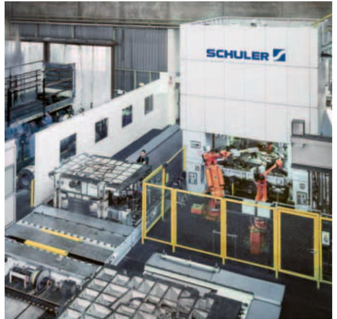
位于德国某家汽车制造厂内用于大批量生产的全自动化管状液压成形系统。
