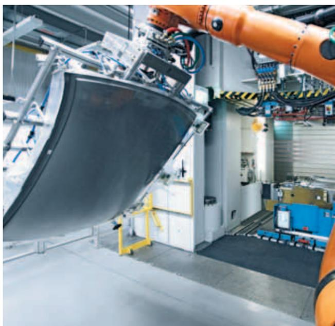
使用机器人自动化技术进行纤维增强塑料零件的制造。
