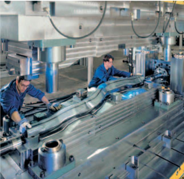
侧向导轨的管状液压成形。
