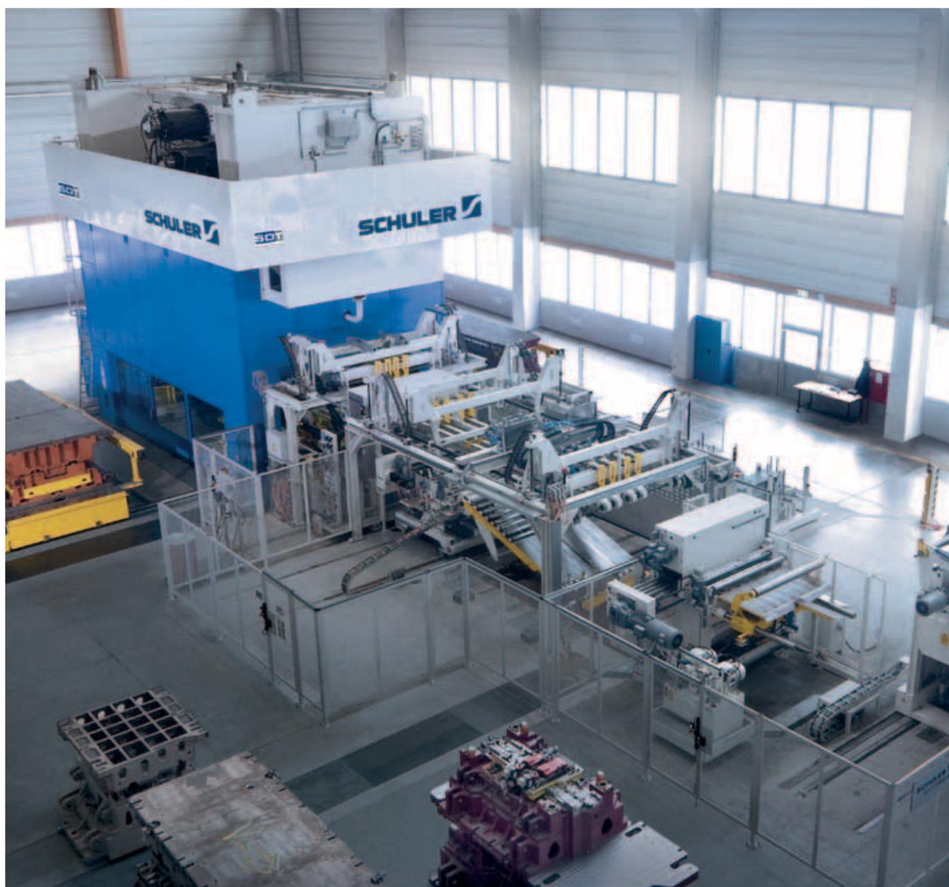
连杆式结构伺服压力机，配备卸垛机/卷料线组合，用于制造高强度结构部件。
