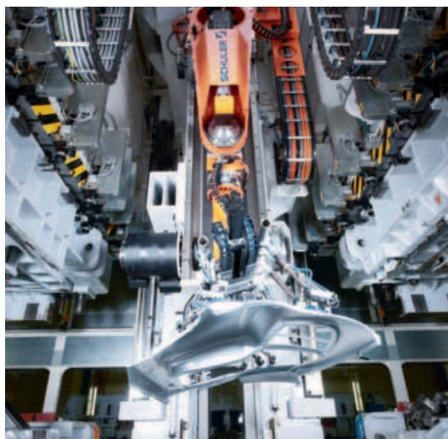
采用伺服直驱技术的冲压线及其自动化部件均具备高度的灵活性，专门用于钢板、高强度钢和铝材的加工。
