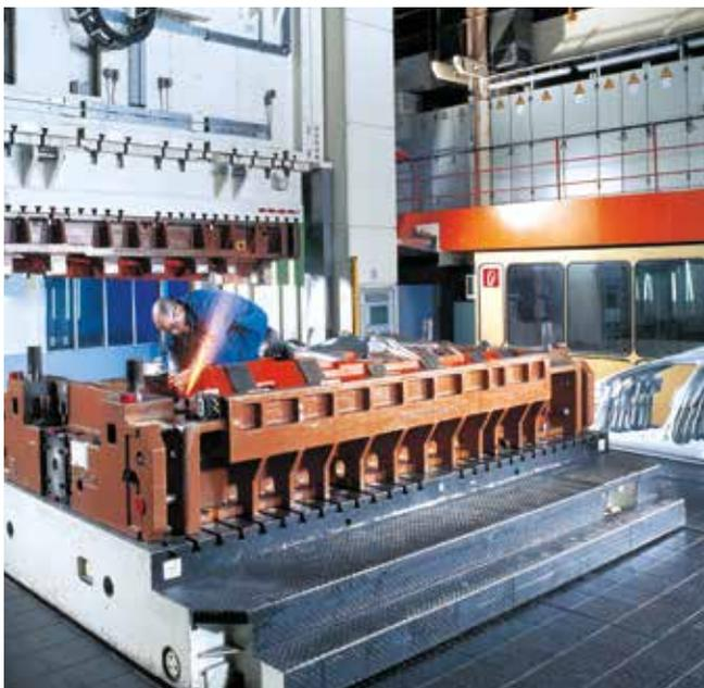
Komfortabler Werkzeugwechsel mit Fahrtischen.
