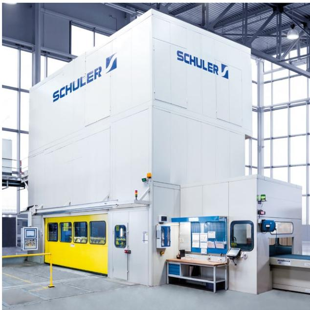
Hydraulische Transferpresse zur flexiblen Teilefertigung.
